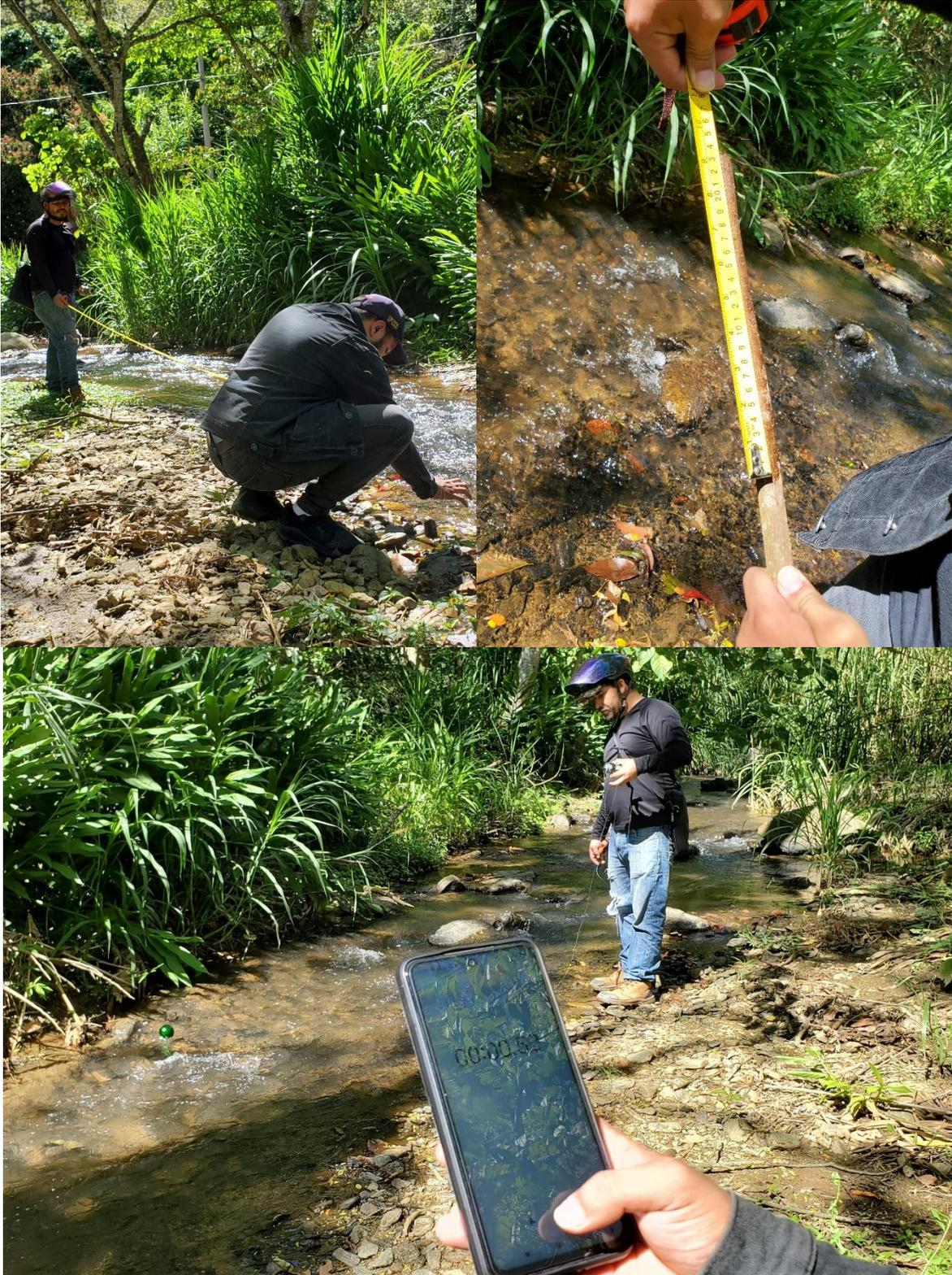
**Medición de tramos y aforo de la fuente**
