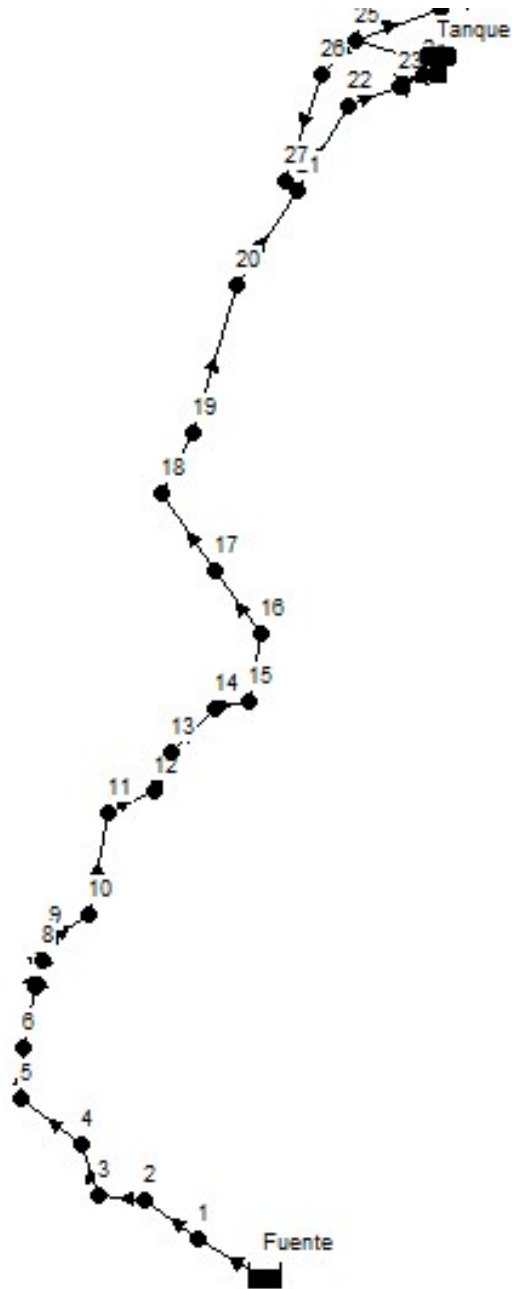
Figura 13 Nodos en línea de conducción
