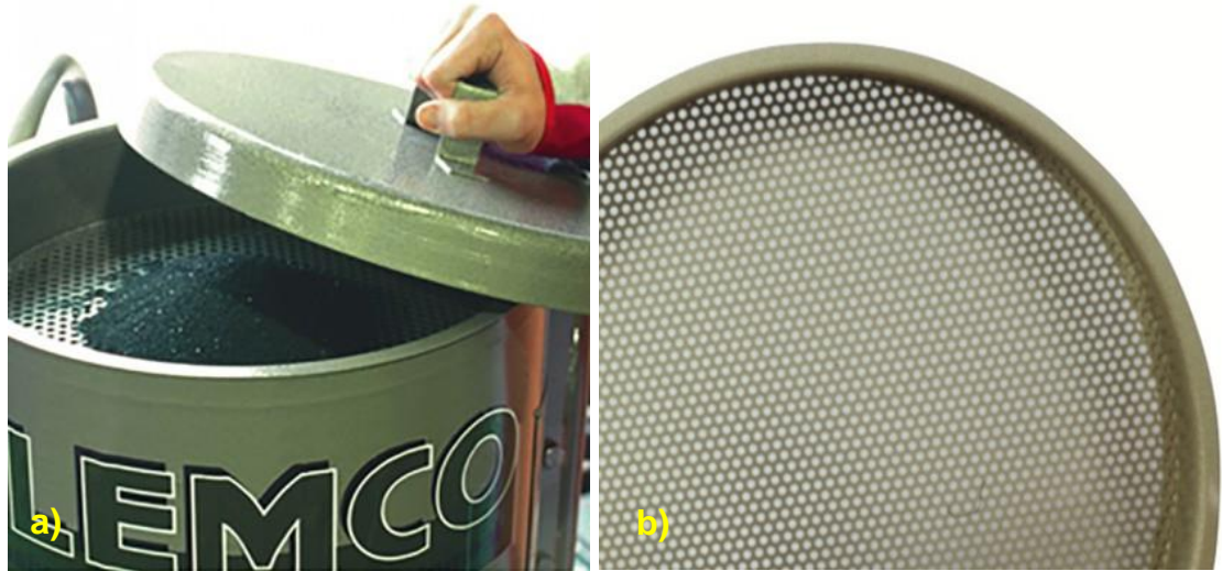
Figura 28: Pantalla (malla) para filtrar directamente al verter el abrasivo en el Clemco; a) Ubicada en el Clemco con abrasivo, b) Vista fuera del Clemco
