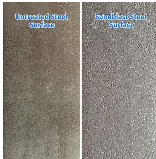
Figura 11: Acercamiento de metal antes y después del sandblasting
