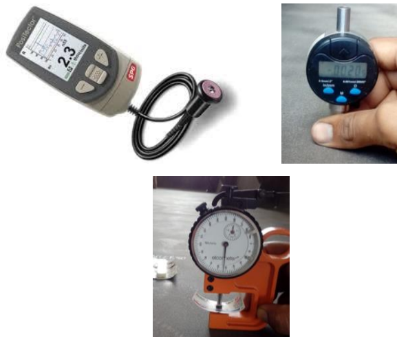
Figura 13: Medidores de anclaje
