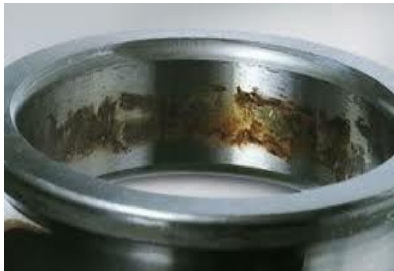
Figura 7: Buje corroído por fricción
