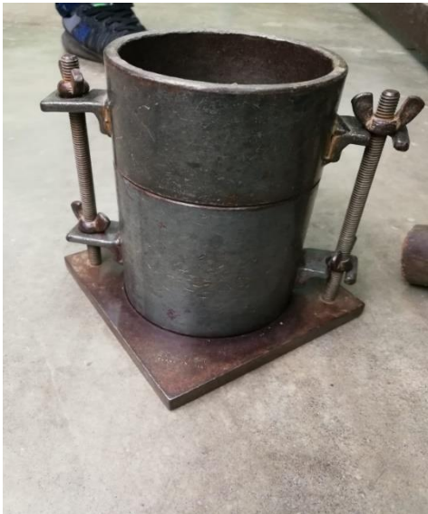
Imagen 11 Preparación del equipo para ensaye de Proctor
