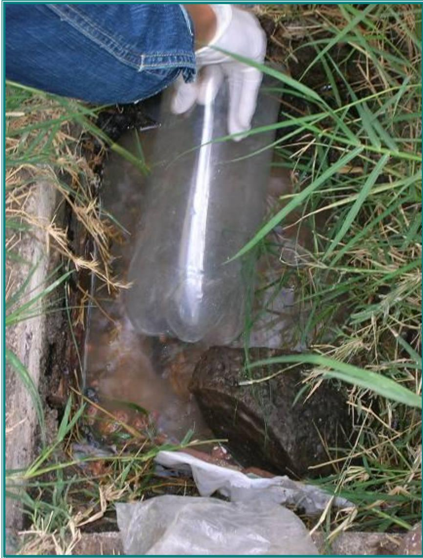
**Foto C.1 Toma de muestra del agua residual a analizar de una caja de registro**
