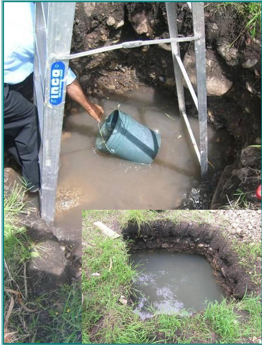
**Foto C.8 Extracción del agua de calicatas**
