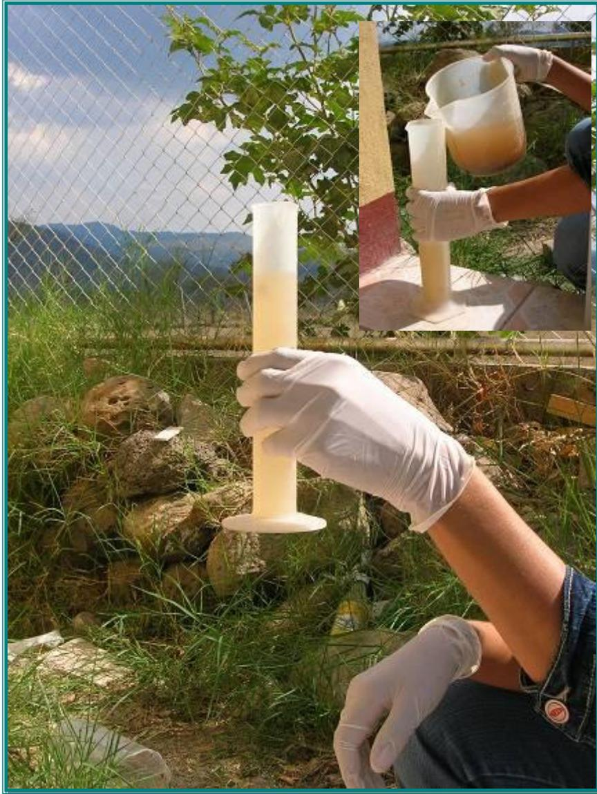
**Foto C. 3** Medición con una probeta graduada de las muestras a recolectar
