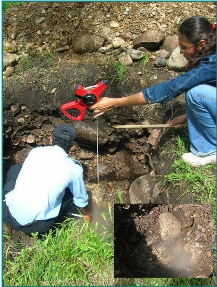
**Foto C.6 Calicatas realizadas para el ensaye de infiltración**
