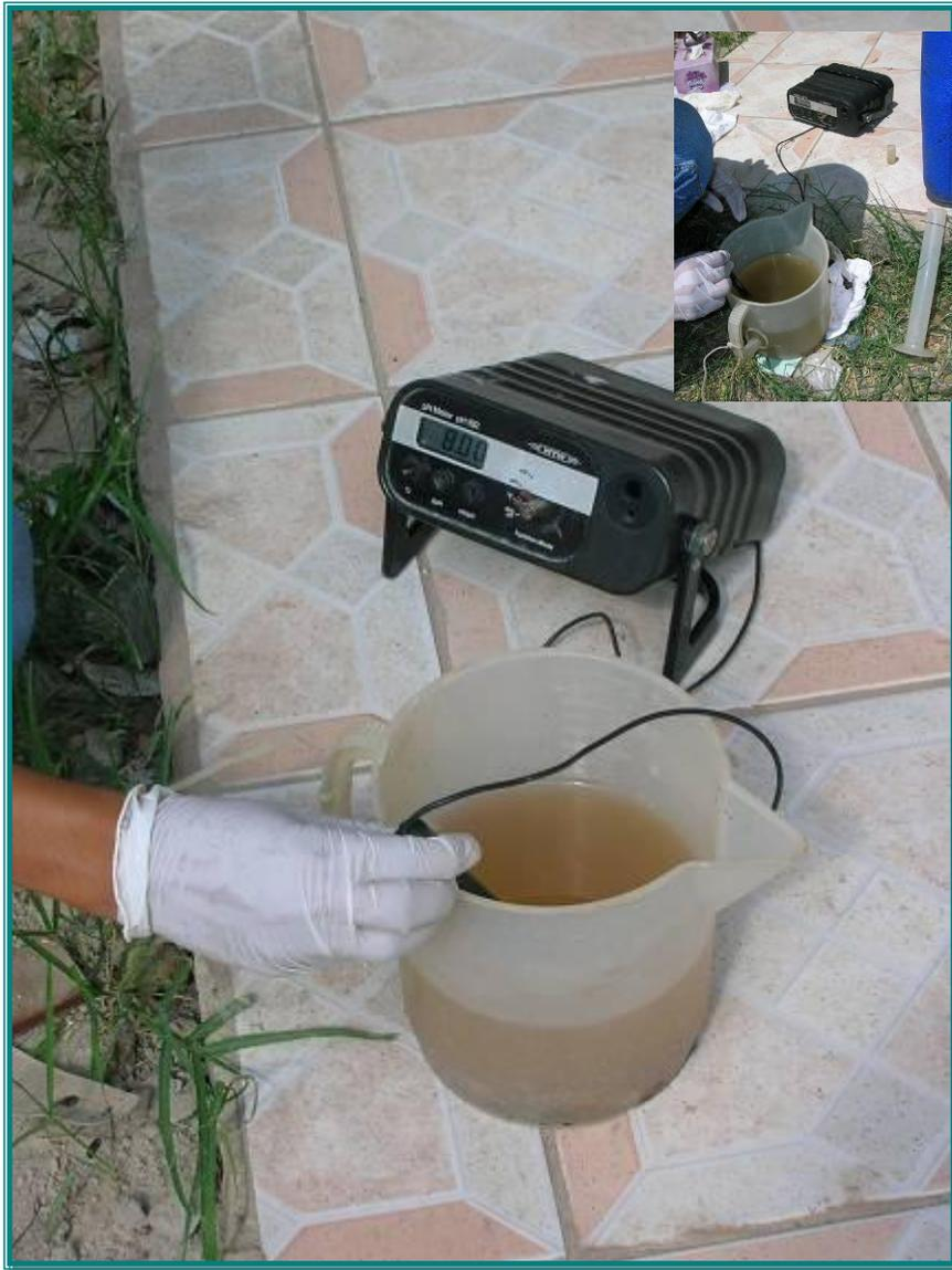
**Foto C.2 Medición PH de la muestra de agua residual**
