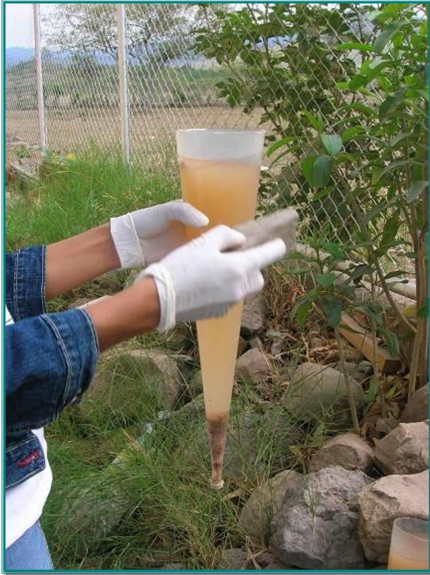
**Foto C.4 Medición de Sólidos Sedimentables con el Cono Imhoff**
