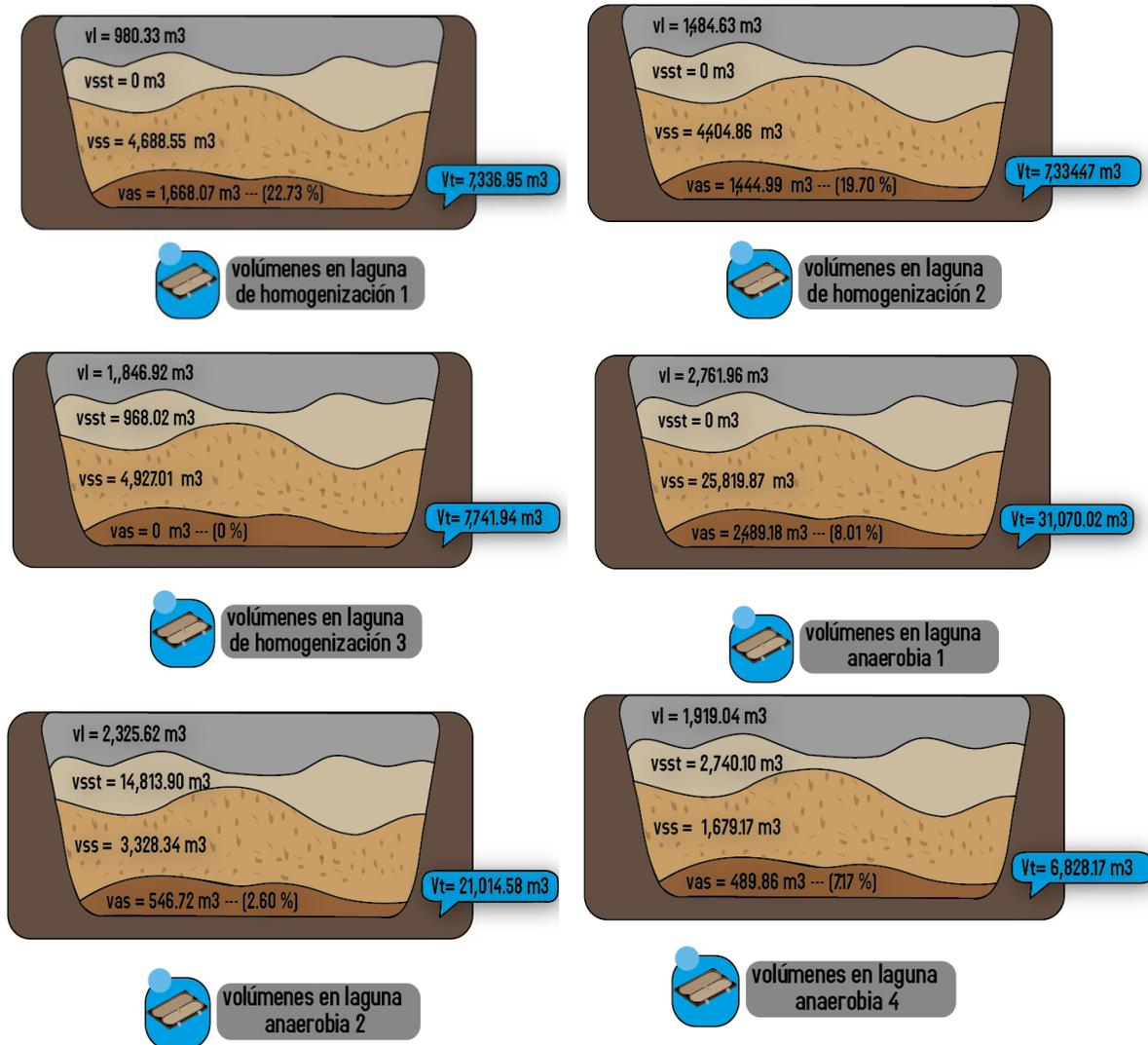
En el diseño y desempeño hidráulico de la unidad de tratamiento y afecta de manera negativa el mantenimiento de las condiciones de la laguna en cuanto a su tiempo de retención hidráulica (TRH), debido a la acumulación de lodos seco reducen el tiempo de retención en las lagunas.
