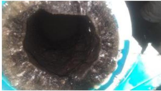
El POME no tiene alcalinidad en sus características físico química, se debe por la recirculación de los lixiviados de las composteras a las lagunas. Al observar la figura 23, se observa cómo se generan incrustaciones en las tuberías, así como, también en el equipo de bombeo debido a las concentraciones alcalinidad.
