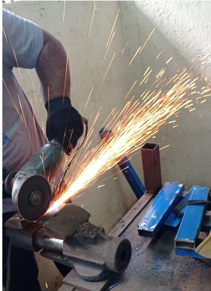
Ilustración VI.2. Método de la chispa para determinación de material.
