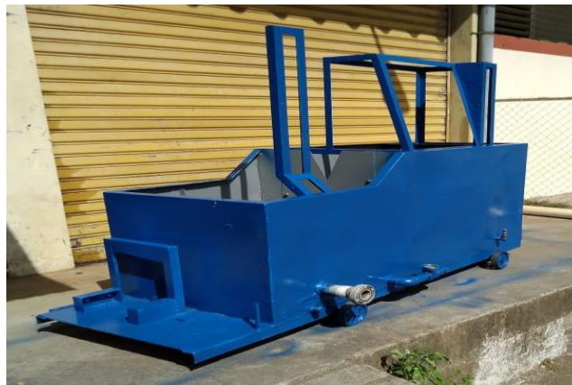
Ilustración VI.6. Aplicación de pintura final a depósitos de succión y descarga.
