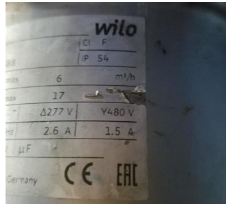
Ilustración VI.10. Ficha característica de la bomba instalada en el banco de ensayo.
