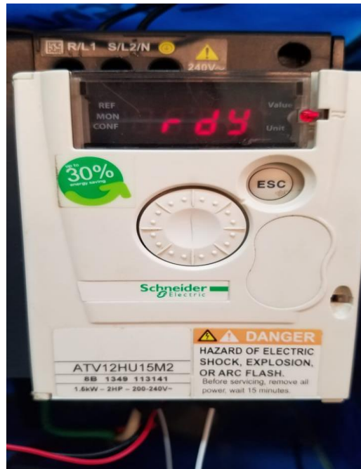
Ilustración VI.21. Variador de frecuencia en función "rdy".
