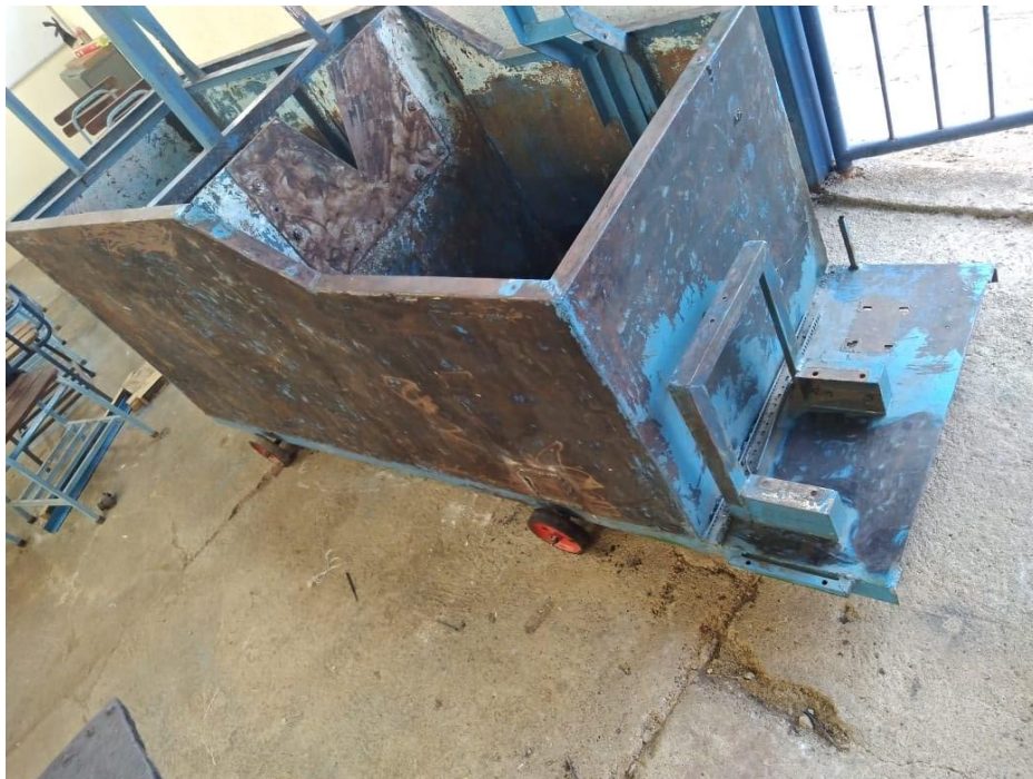
Ilustración VI.1. Depósitos de succión y descarga posteriormente a la remoción de la pintura.
