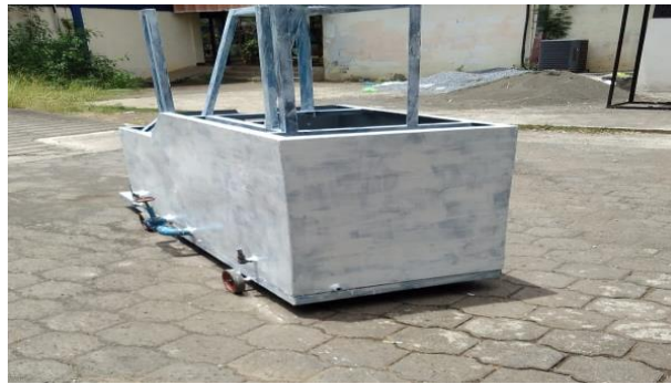
Ilustración VI.5. Aplicación de pintura base a depósitos de succión y descarga.
