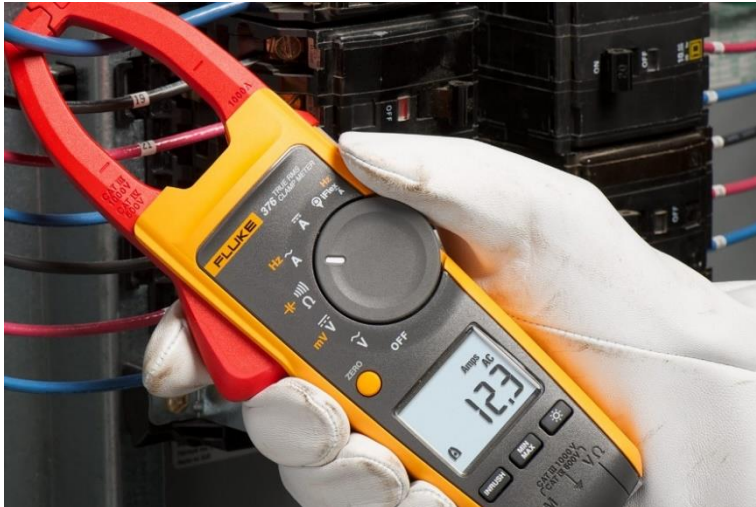
Ilustración 57. Pinza amperimétrica utilizada para las mediciones. Fuente: Elaboración propia.
