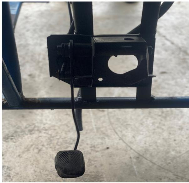
Figura 51. Pedal de embrague con base soldada
