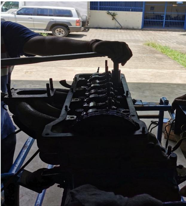
Figura 36. Torque de presion a culata en forma de cruz
