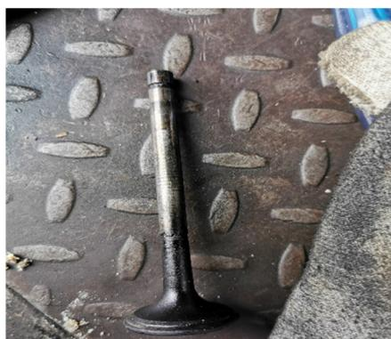
Figura 11. Válvula mal estado
