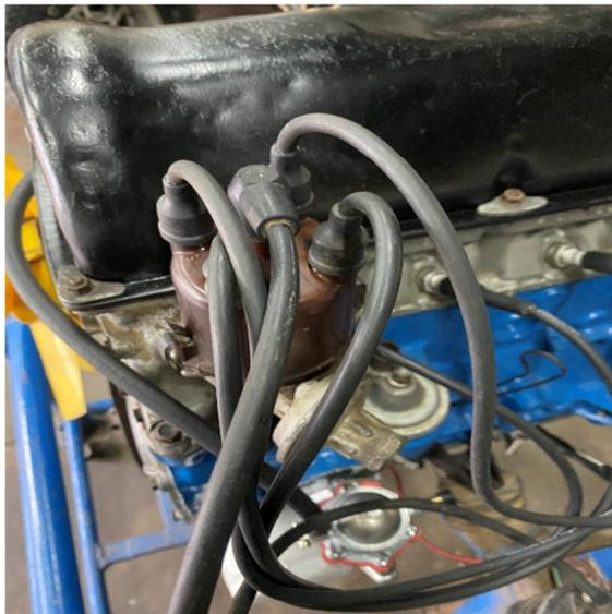
Figura 49. Distribuidor y cables
