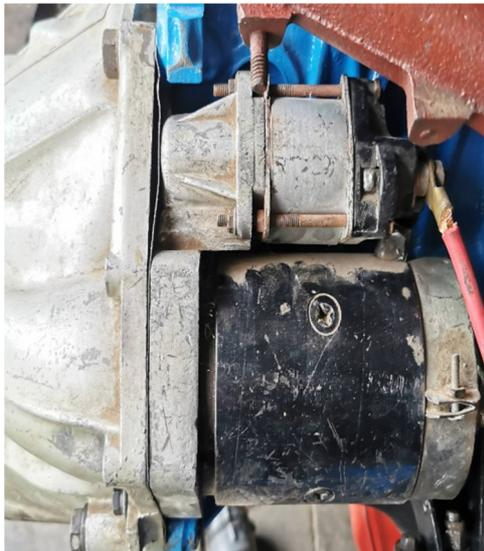
Figura 45. Motor de arranque
