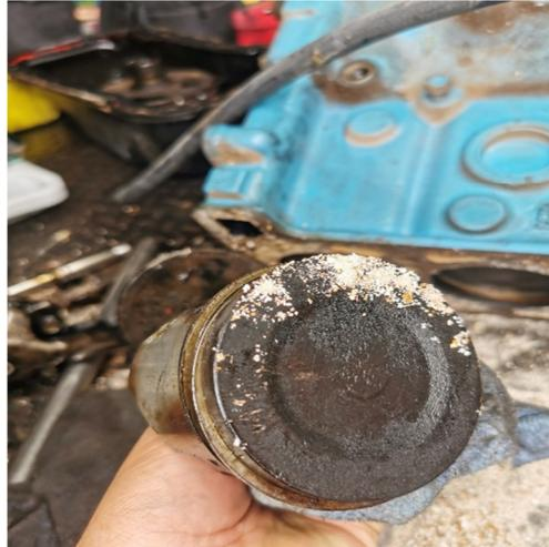
Figura 15. Superficie de pistón carbonizada
