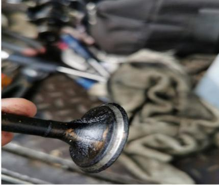
Figura 12. Válvula mal estado
