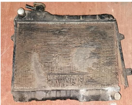
Figura 21. Intercambiador de calor en mal estado
