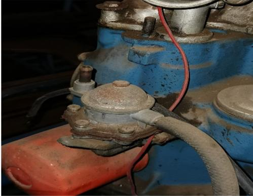
Figura 24. Bomba de combustible en mal estado
