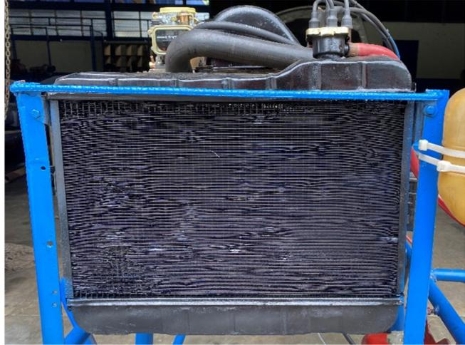
Figura 44. Instalacion Intercambiador de calor
