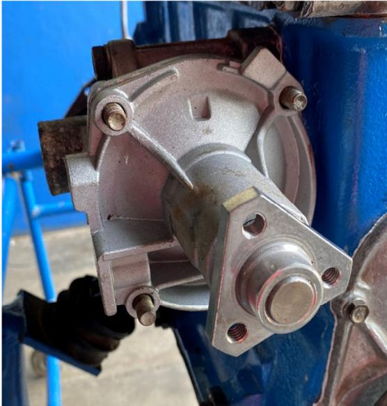
Figura 42. Montaje de bomba de enfriamiento
