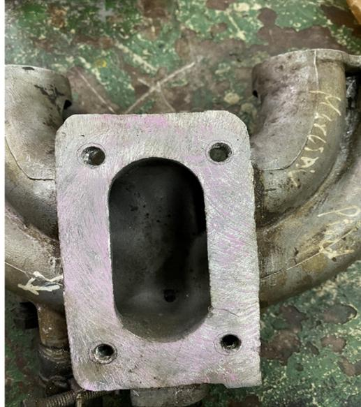
Figura 40. Base de montaje de carburador restaurada
