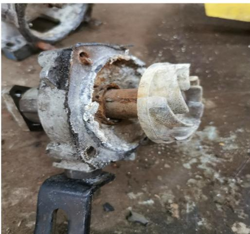
Figura 19. Bomba de enfriamiento oxidada -a
