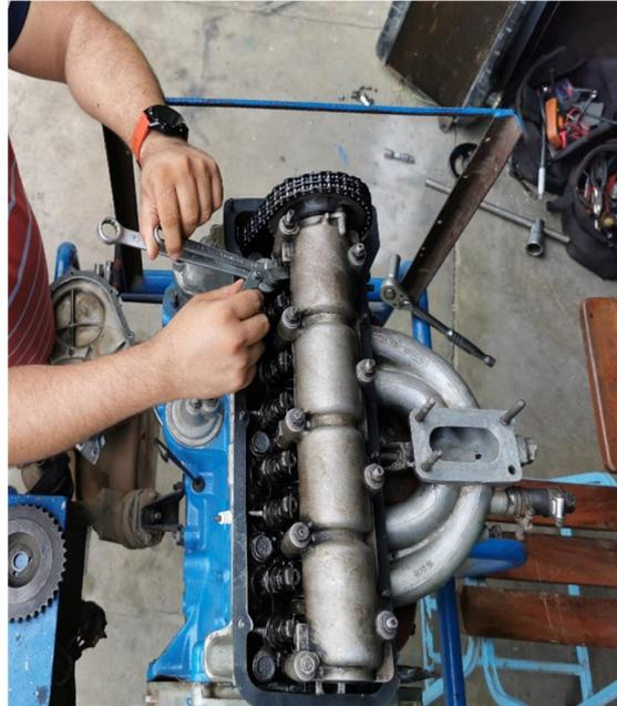
Figura 38. Montaje de arbol de leva
