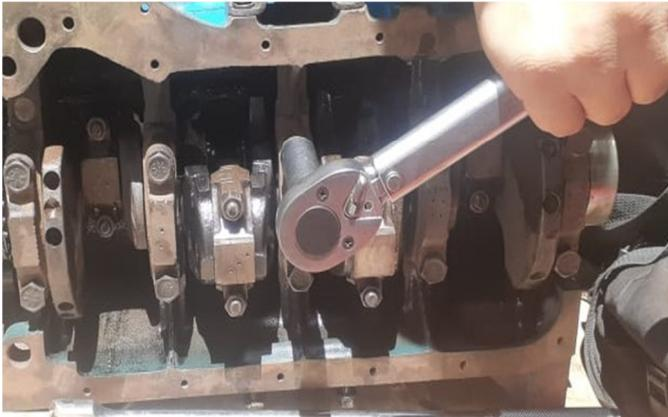
Figura 30. Montaje de cigüeñal y bancadas con su respectivo torque
