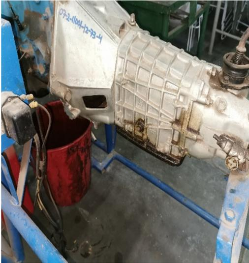
Figura 28 Unión motor y caja de transmisión
