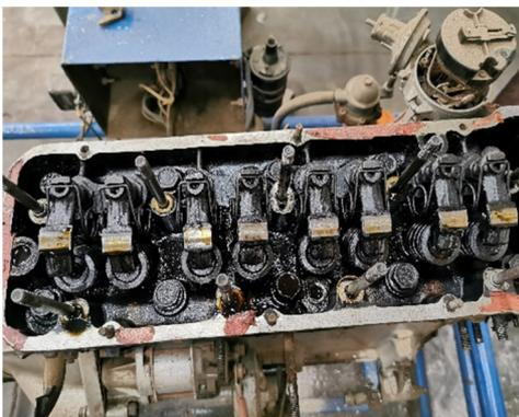
Figura 10. Culata desmontada
