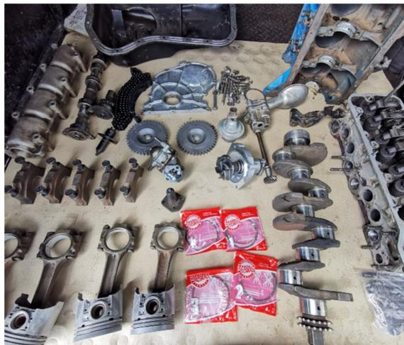
Figura 29. Piezas listas para montar al motor
