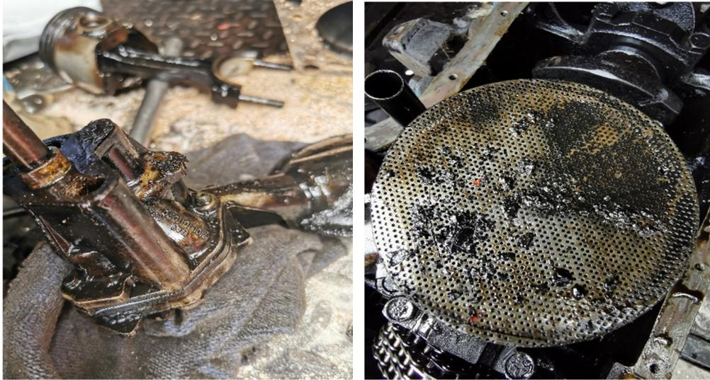
Figura 22. Bomba del sistema de lubricación exceso de residuos
