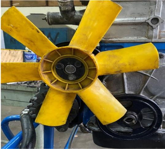
Figura 43. Fan o aspa ventilador seminuevo
