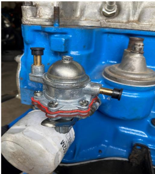
Figura 41. Montaje de Bomba de combustible
