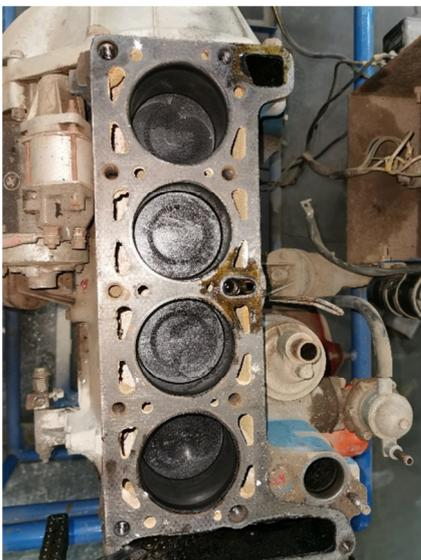
Figura 13. Block desmontado
