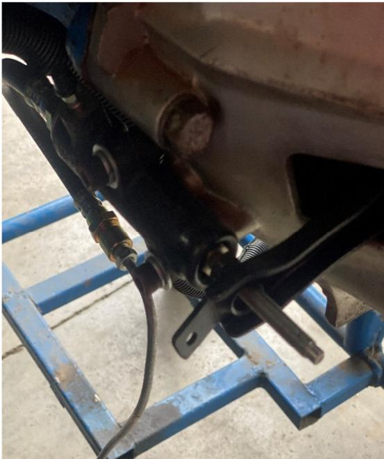
Figura 52. Instalación bomba central de clutch clutch
