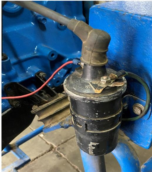
Figura 48. Bobina de encendido
