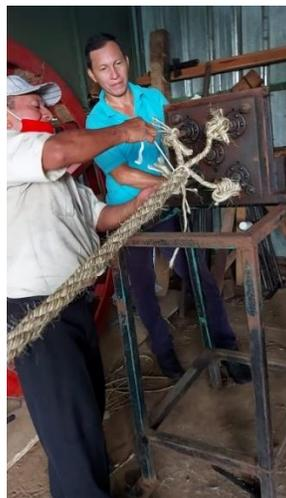
Figura 14. Trenzado de hilo con máquina.
