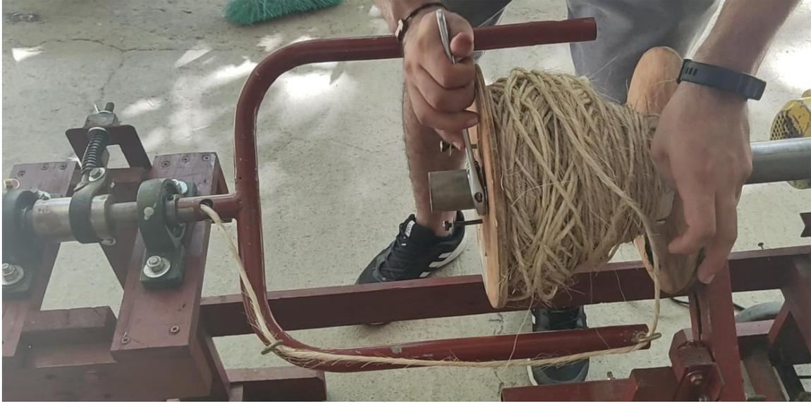
Figura 13. Desmontaje del carrete de la máquina de prototipo.
