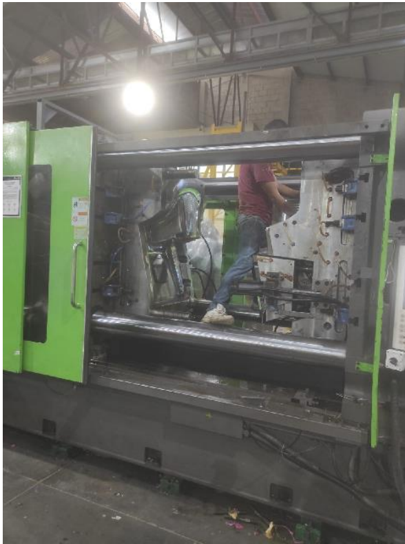
Ilustración 27 Riesgo de atrapamiento
