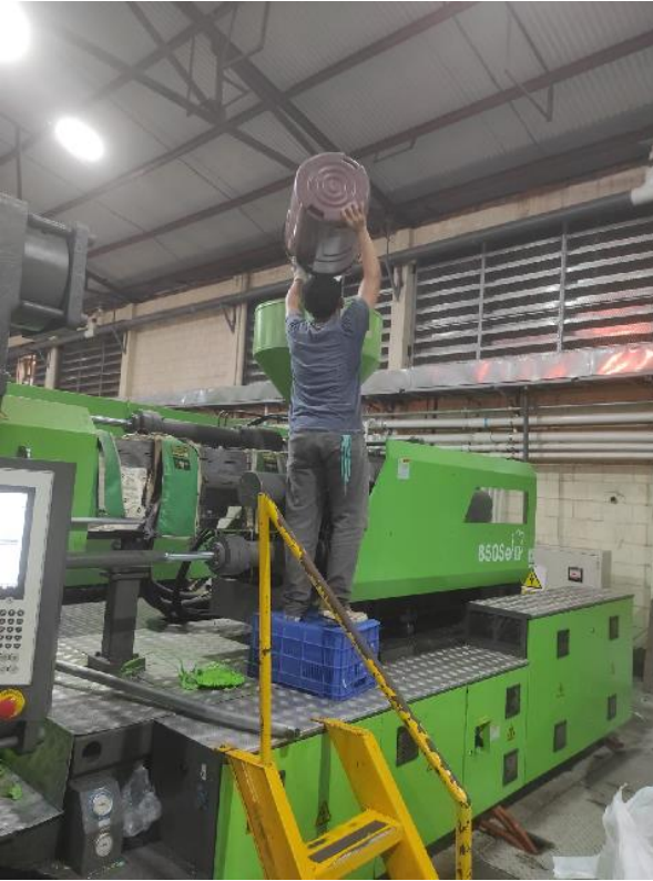
Ilustración 23 Peligro de caída a distinto nivel
