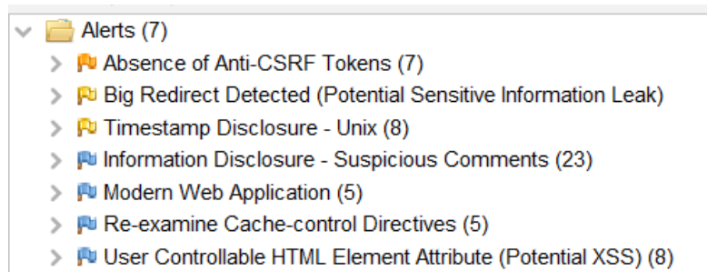
Figura 24: Alertas resultantes del escaneo automatizado con OWASP ZAP hacia el Web Application Firewall.
