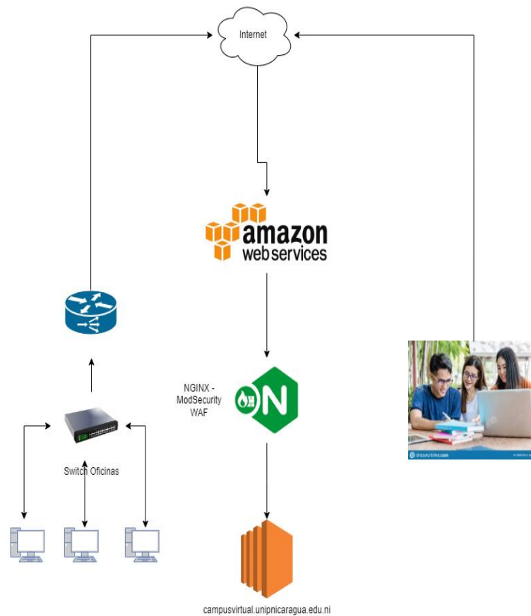
Figura 19: Integración del WAF en la infraestructura tecnológica de la Universidad del Pacífico.
