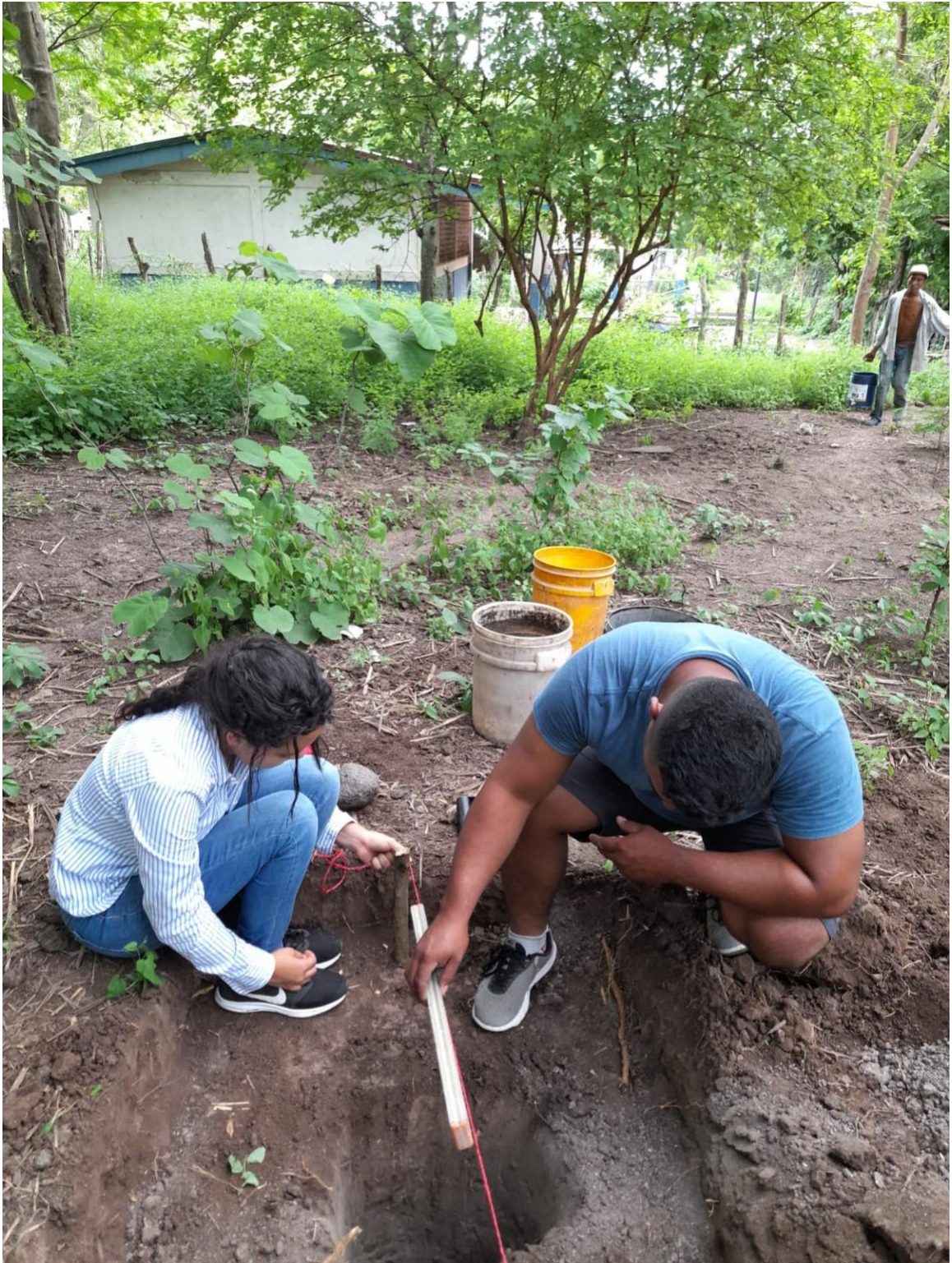
Figura 57 Realización de la prueba de infiltración utilizando el método de Porchet.
