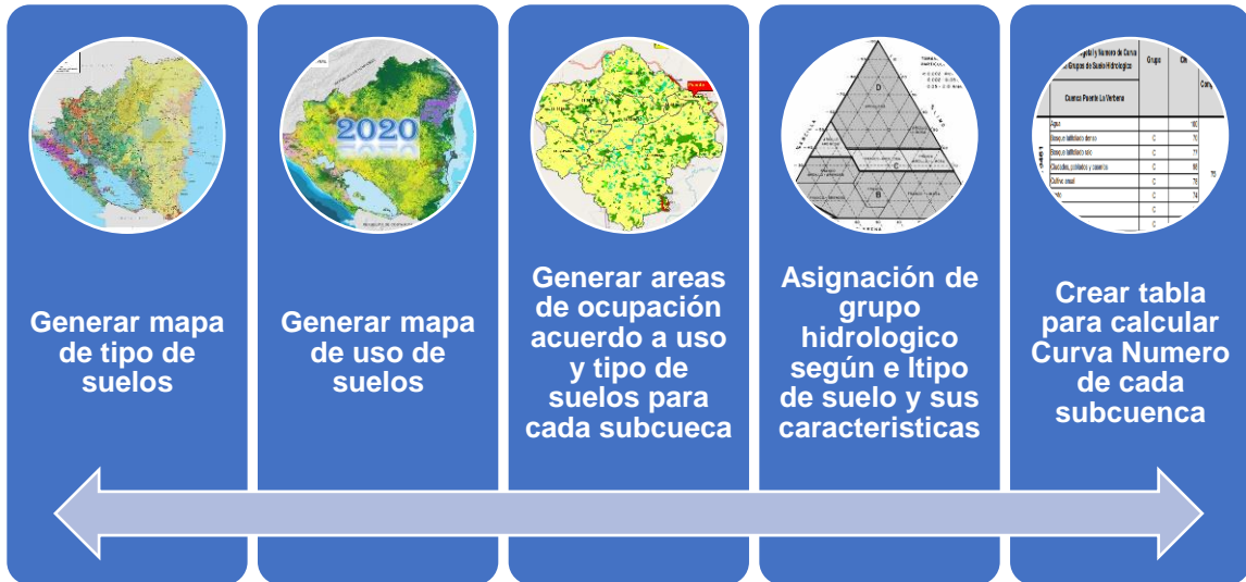
Figura 54. Proceso para calcular el Número de Curva (CN)
