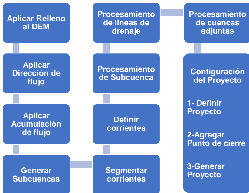
Figura 52. Proceso para delimitar la cuenca en subcuencas en HEC-GeoHMS
