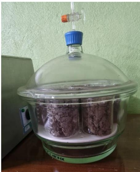
Enfriamiento de los béakers para realizar pesaje de peso seco
