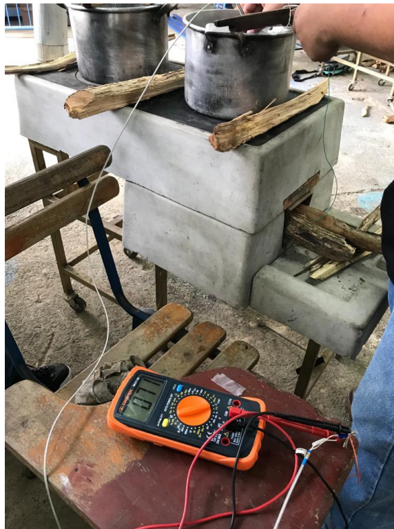
Anexo 9. Prueba de ebullición de agua en cocina ONIL
