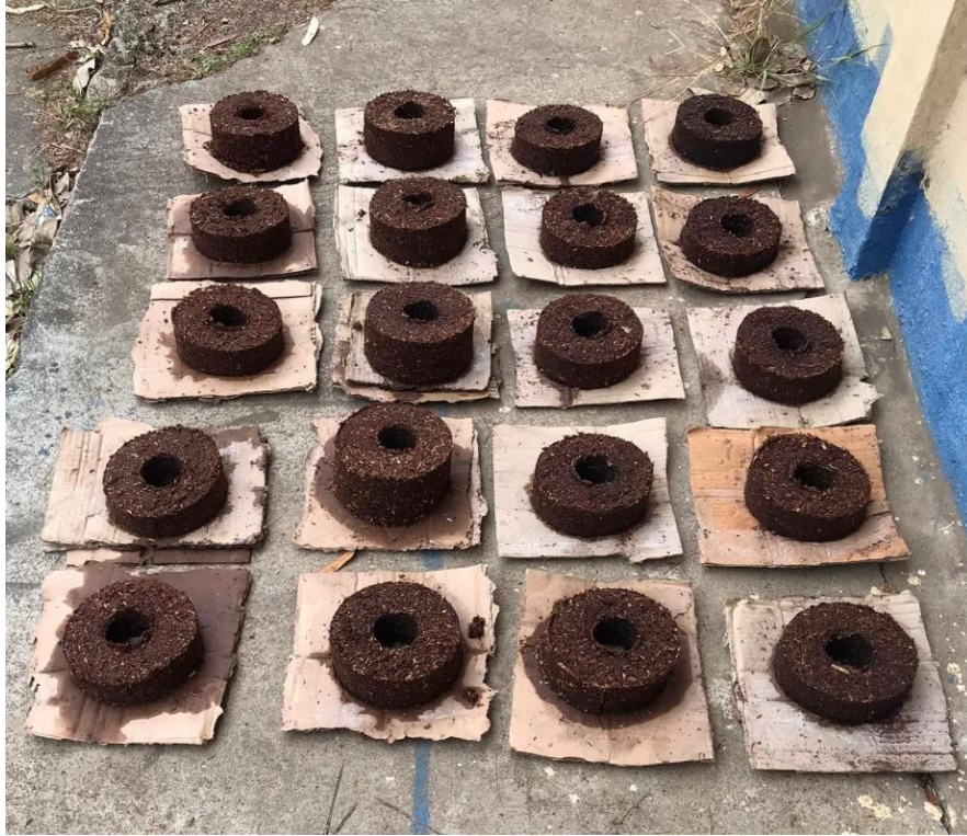
Anexo 8. Secado de briquetas por radiación solar directa
