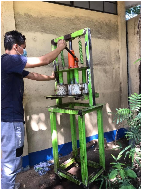
Anexo 6. Compactación de la mezcla Aserrín-Aglutinante
