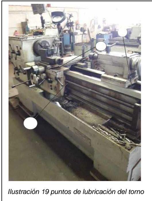
*Ilustración 19 puntos de lubricación del torno*
