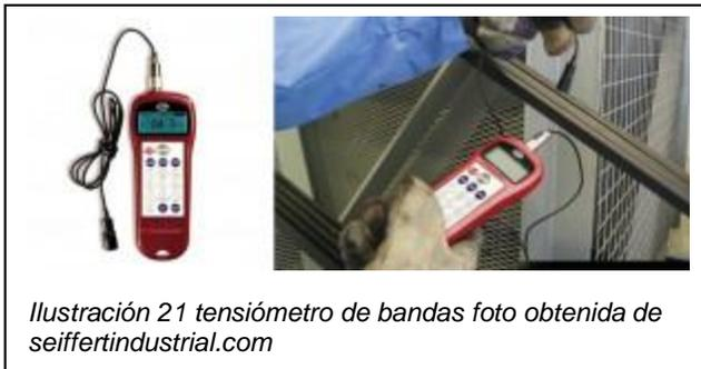
Medición de tensión de la correa con el medidor de tensión Sonic de puertas:
