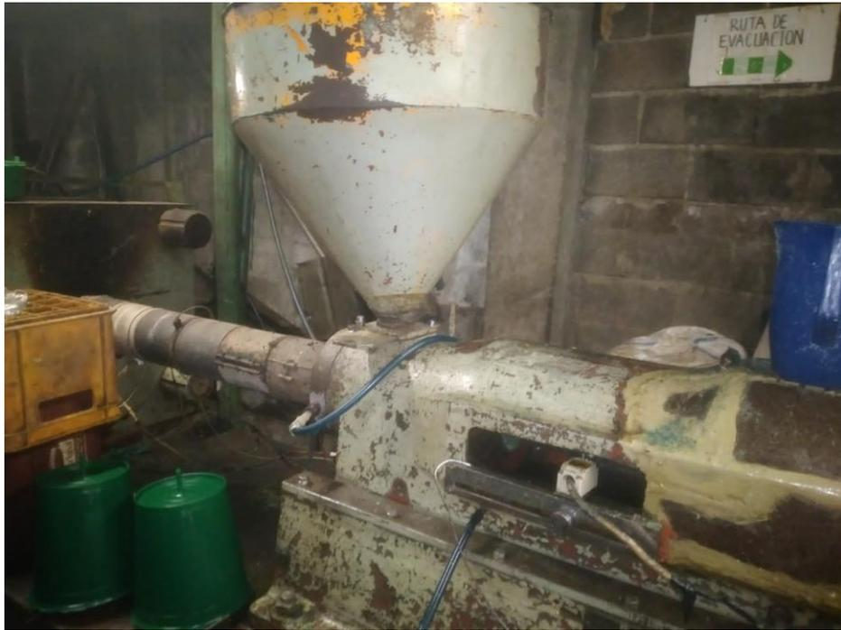
Anexo 9. Tolva de la maquina inyectora donde se agrega el material plástico para fundirlo.
