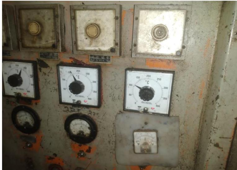
Anexo 10. Sistema de medición por 3 secciones de temperatura para calentamiento. Maquina inyectora de plástico.
