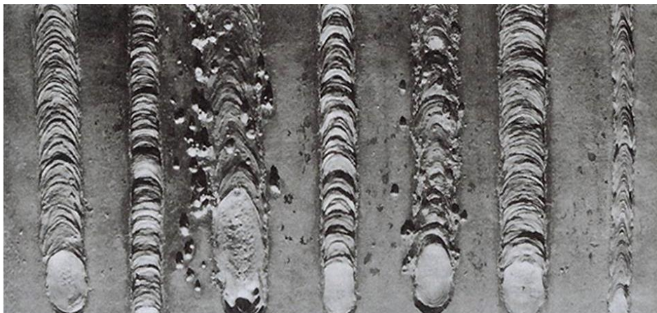
Ilustración N°18: Cordones de soldadura.
