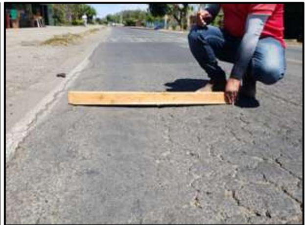
IMAGEN N° 24 y 25: Patologías tipo Desintegración
