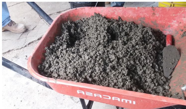
Figura 33. Mezclado de materiales y obtención del concreto permeable.
