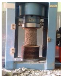
Endayo a compresión (ASTM C 39-03)
