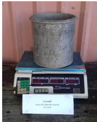
Figura 25. Ensayo de densidad de los agregados según ASTM C29-03.
