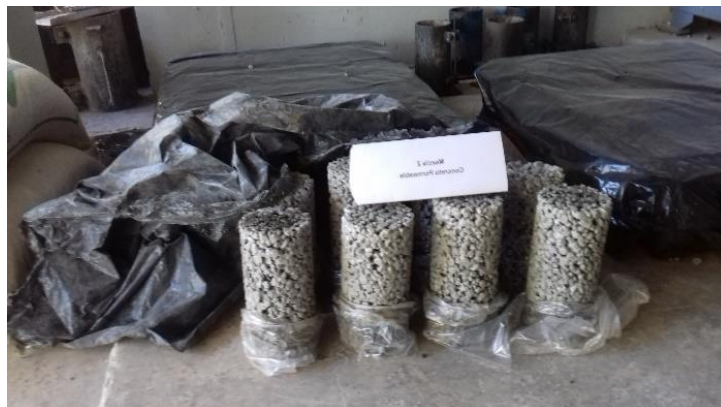
Figura 35. Curado de especímenes en el sitio de fabricación.
