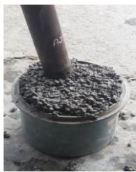
Densidad y Contenido de vacíos en estado fresco (ASTM C 1688-10a)
