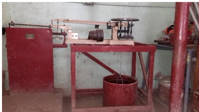
Figura 26. Ensayo de gravedad específica y absorción del agregado grueso según ASTM C 127-01.
