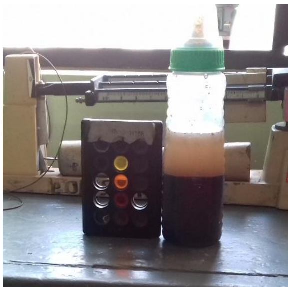
Figura 29. Determinación de materia orgánica en los agregados finos mediante ASTM C 40-11.
