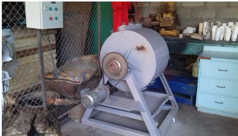
Figura 28. Determinación de la resistencia al desgaste del agregado grueso mediante ASTM C 131-03.
