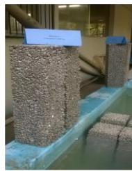
Secado al aire de especímenes de ensayo.
