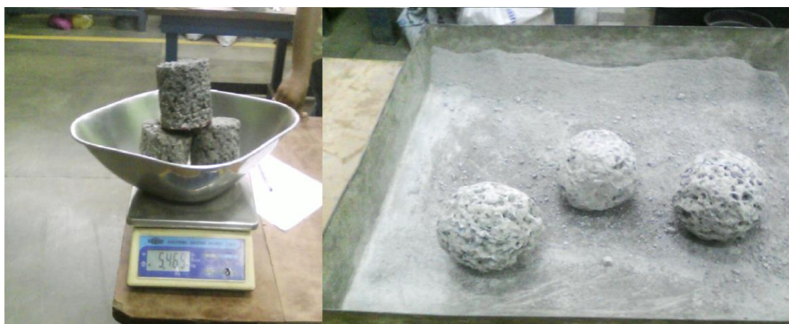
Figura A-11. Ensayo de Resistencia a la degradación según ASTM C 1747.
