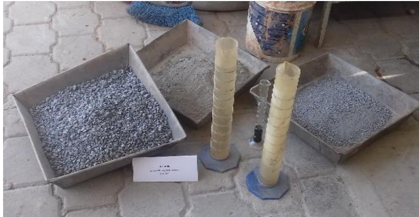
Figura 31. Preparación de materiales para la fabricación de mezclas proporcionadas.
