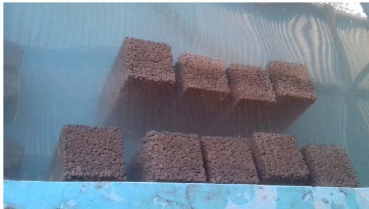
Figura 36. Curado de especímenes en pila de curado.
