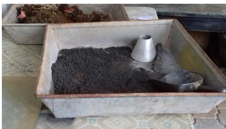
Figura 27. Ensayo de gravedad específica y absorción del agregado fino según ASTM C 128-01.
