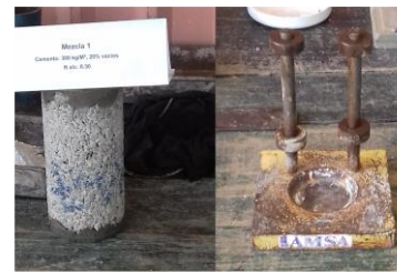
Cabeceo de cilindros (ASTM C 617-10)
