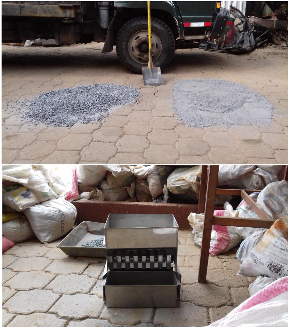
Figura A–2. Reducción de muestras a tamaño de prueba según ASTM C 702.
