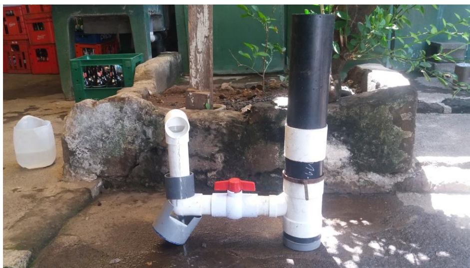
Figura A-9. Ensayo de permeabilidad en laboratorio del Concreto Permeable.
