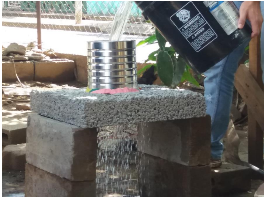
Figura A-10. Prueba de infiltración en losa con dimensión de 0.50 mt. x 0.50 mt. según ASTM C 1701-09.
