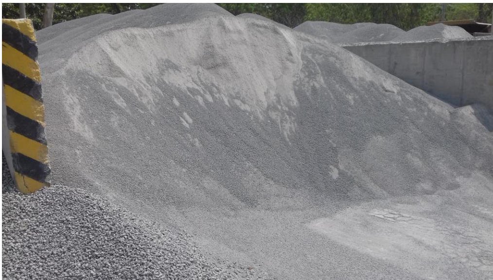
Figura 22. Banco de agregados de tamaño nominal máximo de 1/2" de PROINCO.
