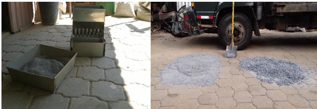
Figura 23. Secado y Reducción de muestras de agregados a tamaños apropiados para ensaye según ASTM C702-98 (Método A).
