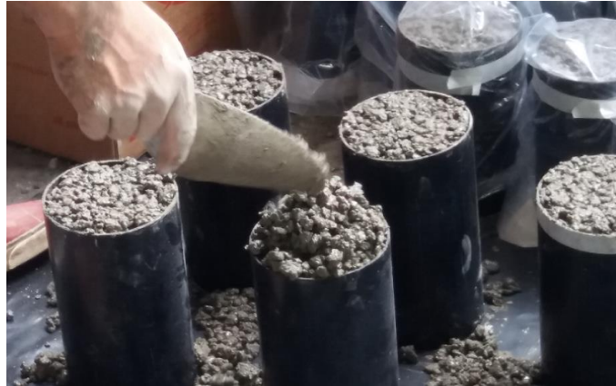
Figura 34. Fabricación de especímenes de 4"x8" para ensayo a compresión.
