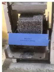
Ensayo a flexión (ASTM C 78-09)
