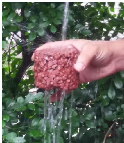
Figura 6. Concreto permeable en estado endurecido.
