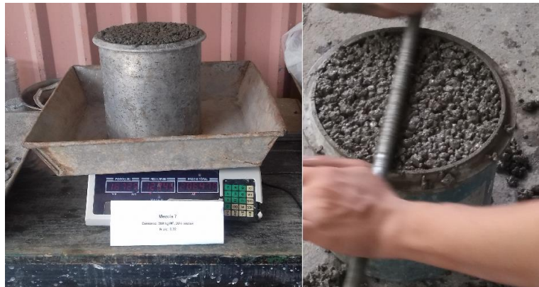
Figura 45. Ensayo de Densidad del Concreto permeable según ASTM C 1688.
