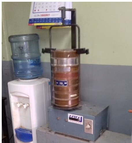
Figura 24. Análisis granulométrico de los agregados según ASTM C136-06.
