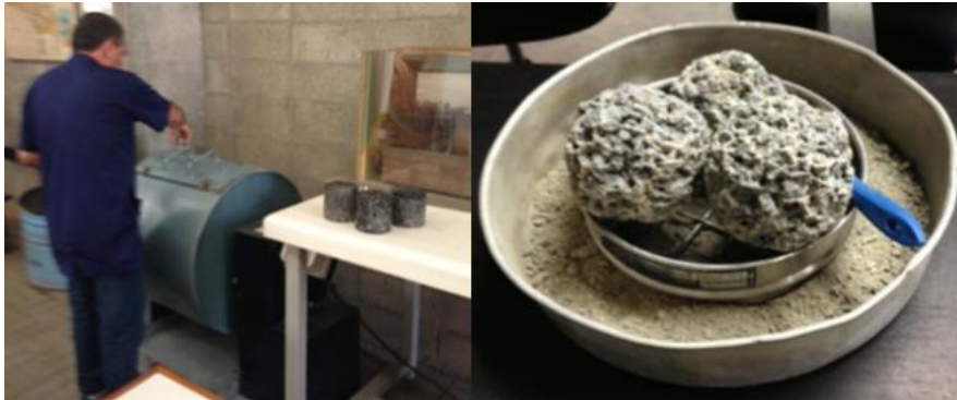
Figura 20. Resistencia a la degradación por impacto y abrasión del concreto permeable.
