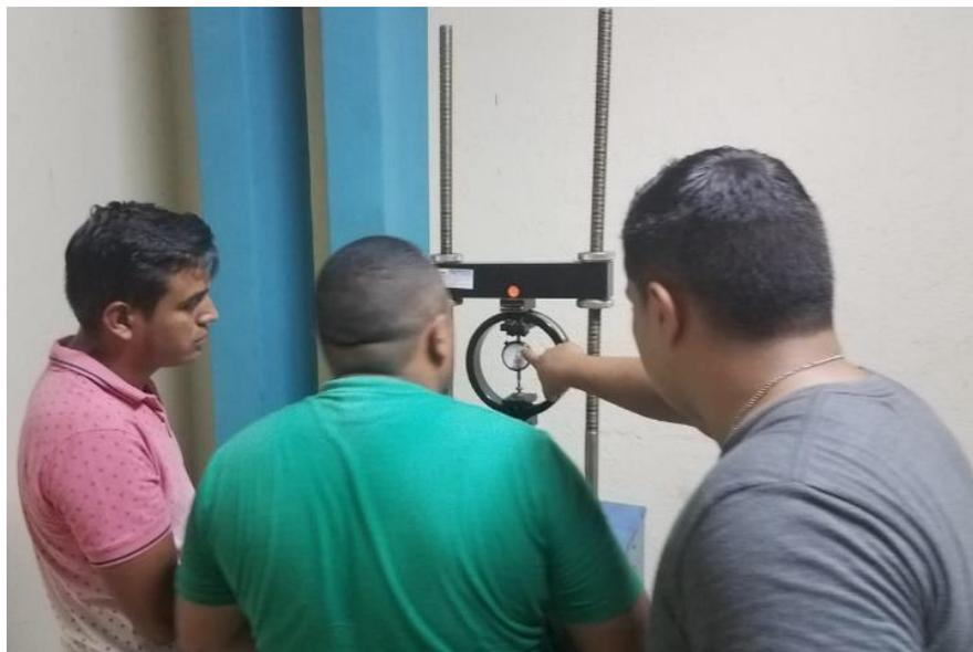
**Figura 22: Determinación de la estabilidad y flujo en el aparato Marshall, Fuente: Los autores, Laboratorio INSUMA**
