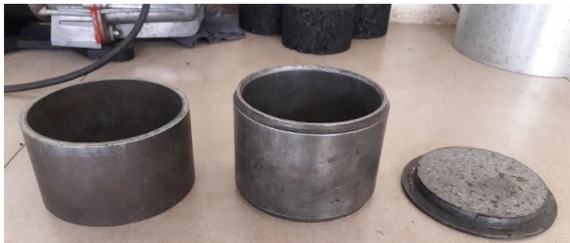
**Figura 30: Moldes de Compactación Marshall, Laboratorio INSUMA**
