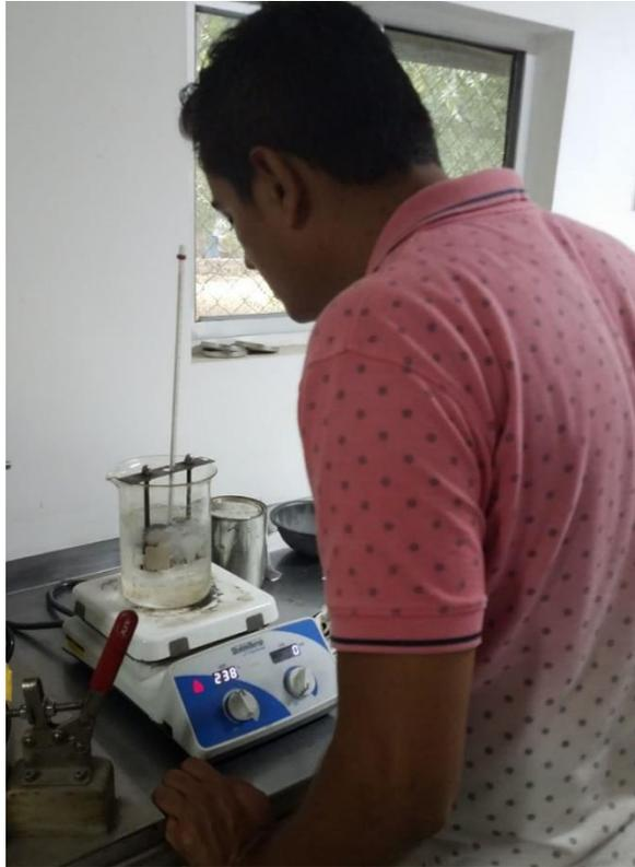
**Figura 25: Determinando el punto de ablandamiento del asfalto, Laboratorio SOLTEC**
