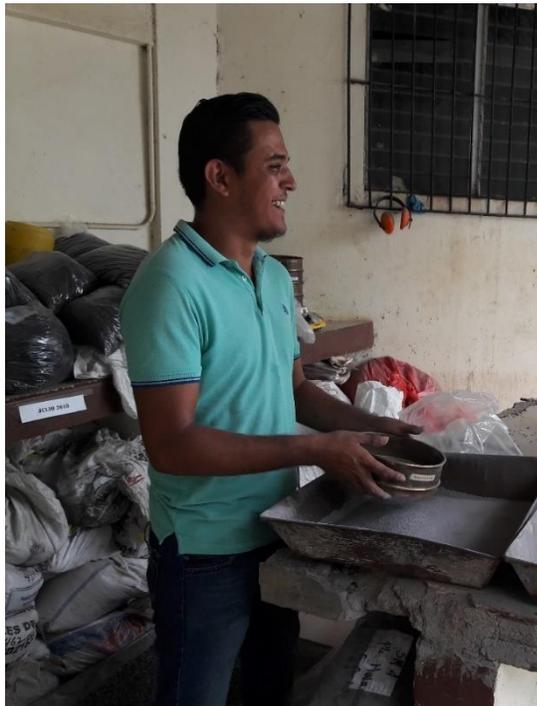
**Figura 3: Proceso de tamizado para determinación de Granulometría de Agregados, (fuente: autores, Laboratorio de INSUMA)**
