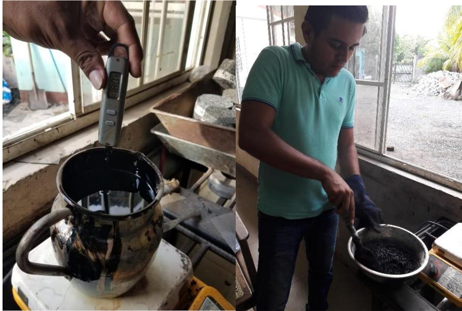
**Figura 28: Verificación de la temperatura de mezclado. Figura 29: Proceso de mezclado de briquetas, Laboratorio INSUMA**
