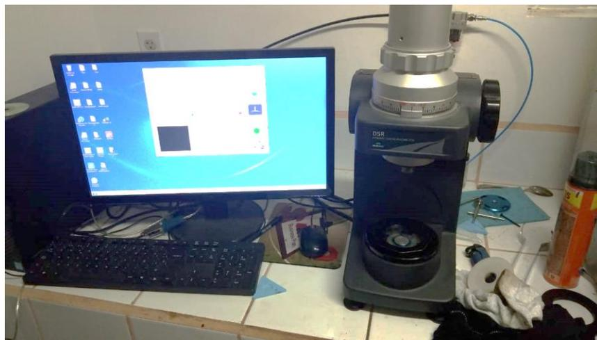
**Figura 17: Reómetro de Corte Dinámico, Laboratorio SOLTEC, S.A**
