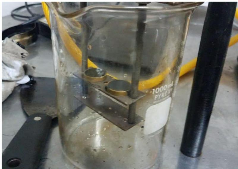
**Figura 15: Ensayo de anillo y bola en Laboratorio SOLTEC, S.A,
