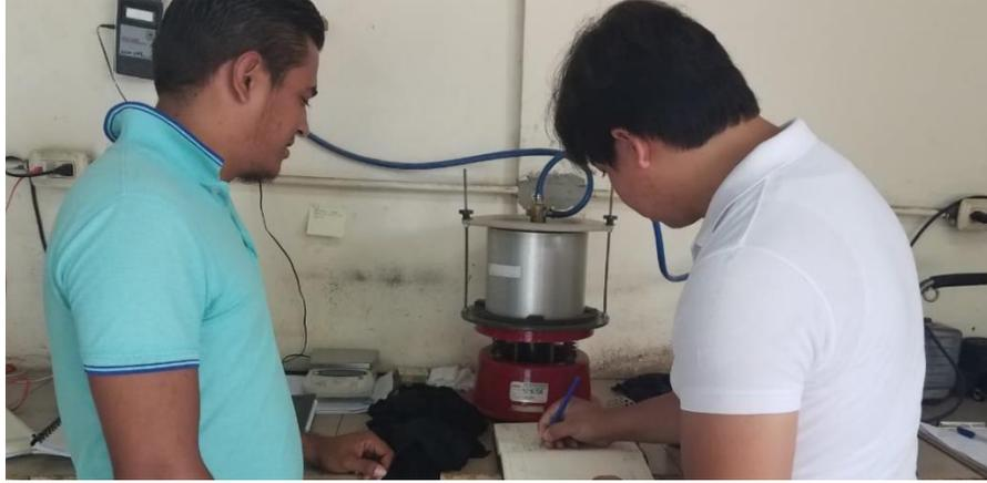
**Figura 27: Determinación de la Gravedad Teórica Máxima, INSUMA.**
