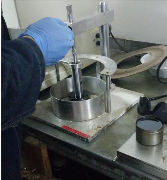
**Figura 23: Realizando Ensayo de Recuperación Elástica por Torsión, Laboratorio SOLTEC**
