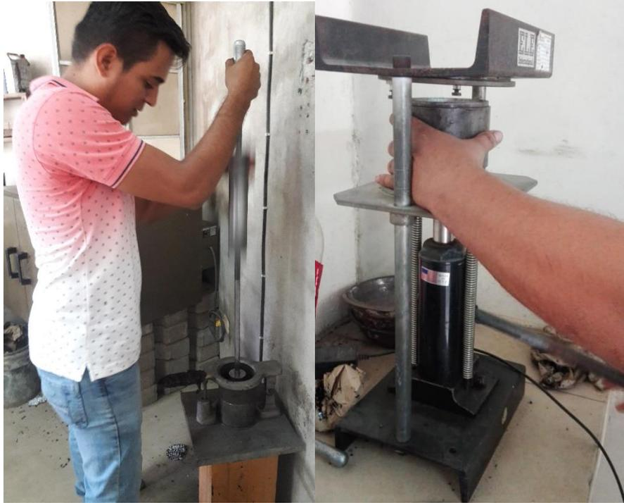
**Figura 31: Proceso de compactación y Extracción de briquetas**
