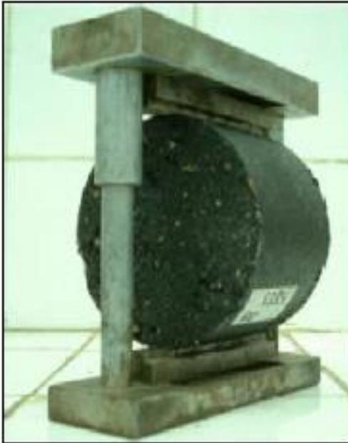
**Figura 20: Espécimen de prueba para ensayo de tensión diametral**
