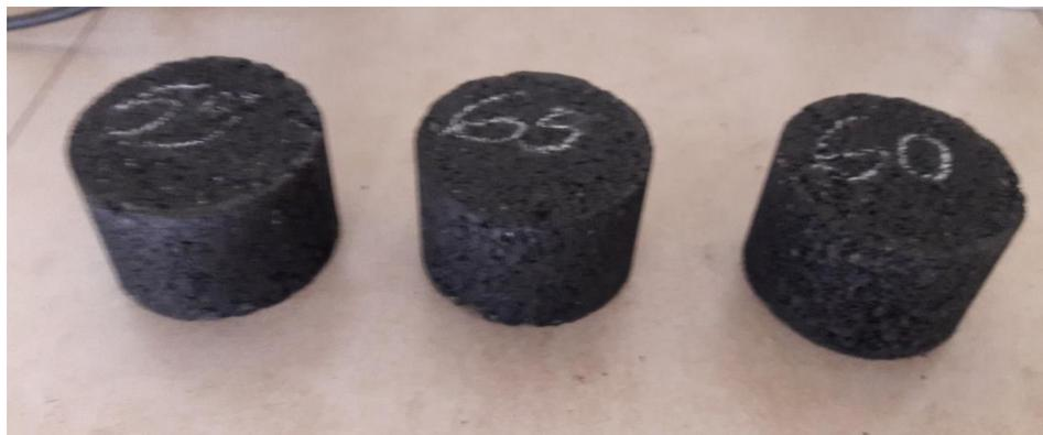
**Figura 18: Briquetas con diferentes contenidos de asfalto, Laboratorio INSUMA, fuente: autores**
