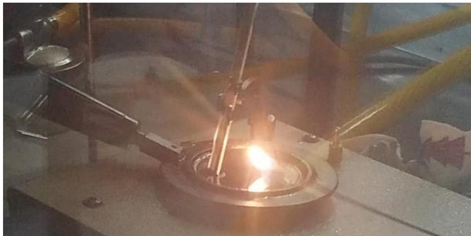
**Figura 16: Determinación del punto de inflamación del ligante, Laboratorio SOLTEC, S. A, fuente: Autores**
