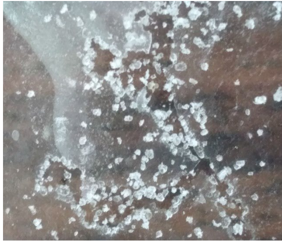
Figura 27. Inicio de la degradación en la superficie del polímero en contacto con el alimento.
