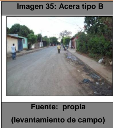
El tipo B se encuentra en vías principales y secundarias del barrio tiene un ancho máximo de 1.5m de acera que desciende hasta 0.3m, con juntas de expansión a cada 1.5m; en algunos tramos este tipo no posee área verde y genera discontinuidad de la vía peatonal. La disminución de acera se debe a la lotificación arbitraria que expande las construcciones ocupando el área destinada para la vía pública. A continuación se
