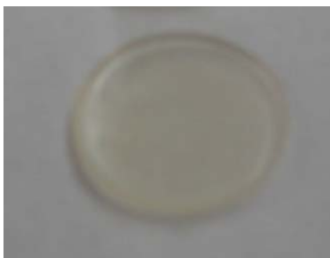
Figura 22: Polímero obtenido a partir de formulación Aceite de Soya Tionado – Trialilcianurato (AS-CN).
