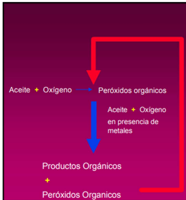
Figura 12 La oxidación de aceite.
