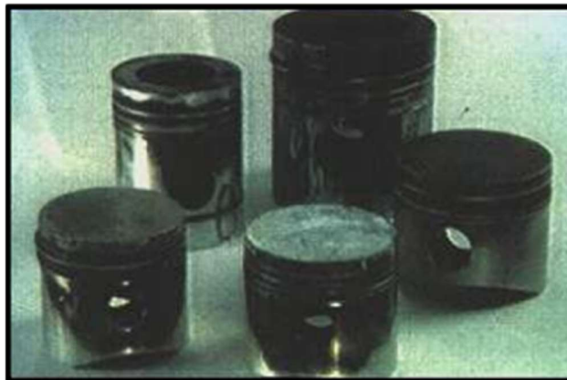
Figura 6 Formación de depósitos en los pistones-un resultado de la oxidación de películas delgadas de aceite a altas temperaturas.
