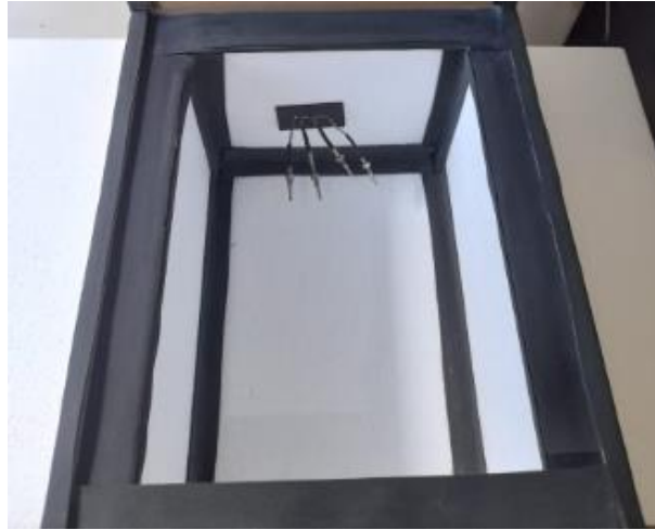
Figura #7 Cavity Aislada de dispositivo de placa protegida en material poliestireno expandido y Foam tape 2023, Managua
