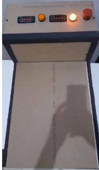
Figura #19 Instalación de tapa de dispositivo aislada con poliestireno, 2023, Managua
