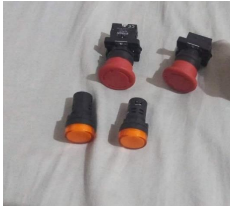
Figura #17 luces piloto y paros de emergencia con accionamiento Normalmente cerrados, estos permiten o cortan el paso de la corriente eléctrica a través del circuito eléctrico, Marca: Steck, 2023, Managua
