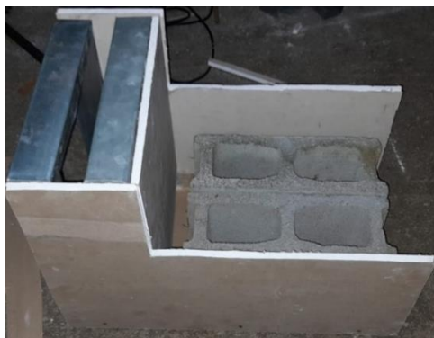
Figura #5 Ensamblaje de armazón de dispositivo de placa protegida en material tabla yeso (GYPSUM) con refuerzos en lámina aluminio, 2023, Managua
