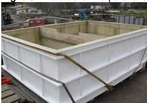
Fig. 5.3.1 Foto de la Pila para lavar los pipianes
