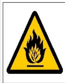
Riesgo de incendio
