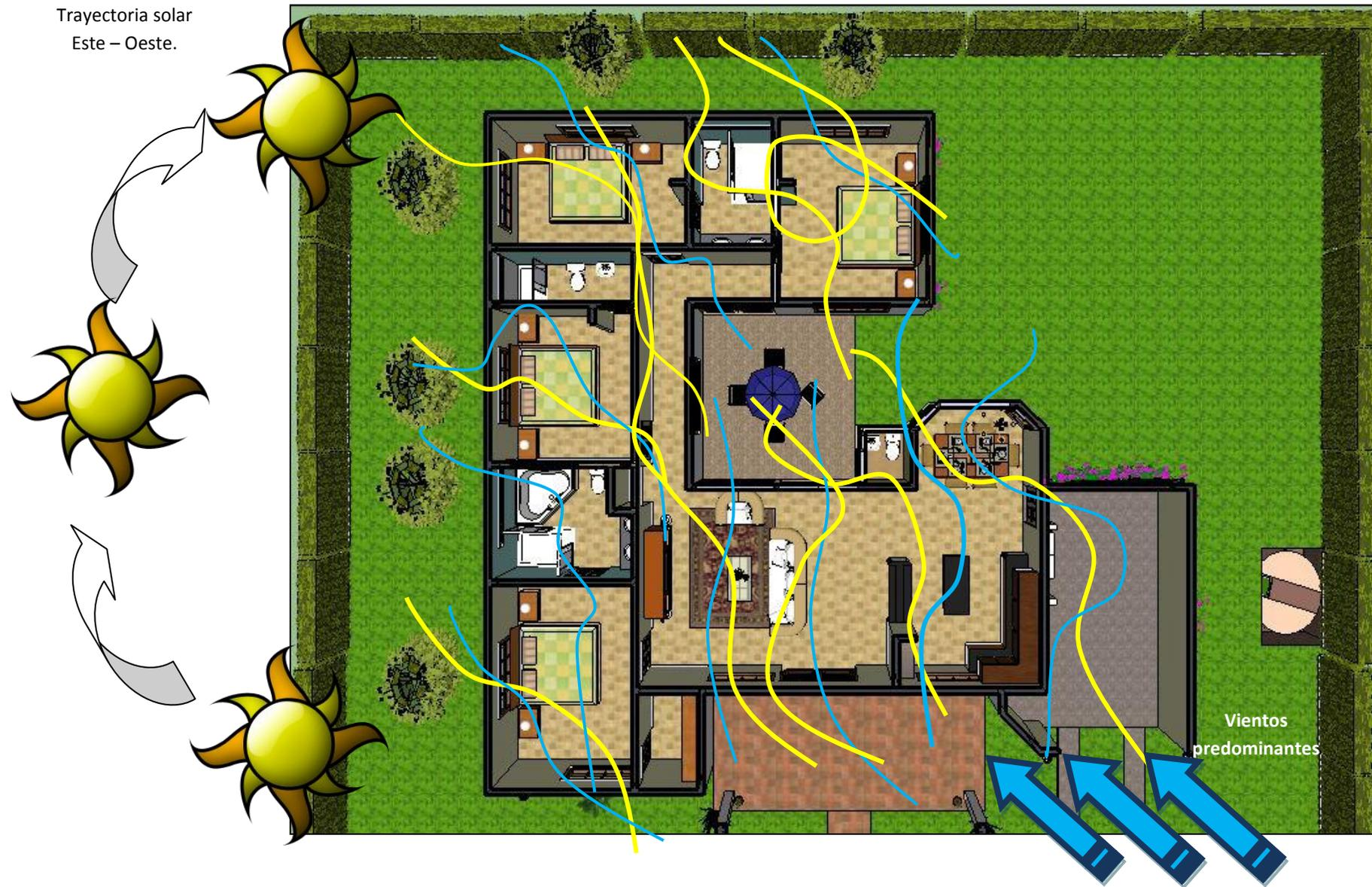
Cada factor climático que se presenta en la imagen corresponde a las direcciones exactas de acuerdo a los datos recopilados por INETER y estudio del sitio, obteniendo gráficos a escalas y demostradas en modelo cargado en software de Vasari y Ecotect. De esta manera se observa como atraviesan los vientos predominantes de Este a Oeste, cruzando toda la vivienda ayudando así a la ventilación natural.
