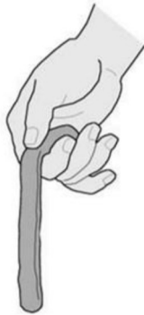
Ilustración 27 -Ensayo de cinta – Fuente: PROTOCOLO DE ENSAYOS PARA MATERIALES DE CONSTRUCCION CON TIERRA: ADOBE, BTC, TAPIAL Y MORTERO
