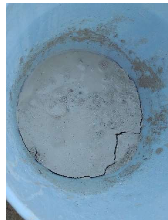
Ilustración 30 - Cal viva humedecida, para hacer cal hidratada. Fuente: Propia autoría.
