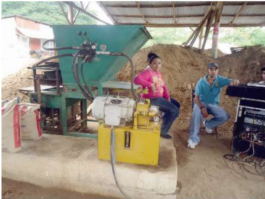
Ilustración 8 - Máquina industrial para elaborar BTC – Fuente: Bolsa de Noticias
