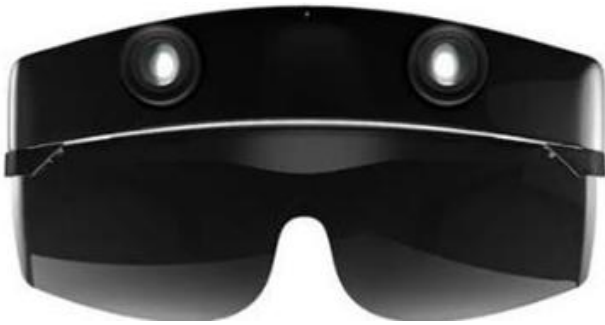
Figura 21. Gafas que Detectan Objetos y lo Trasmiten mediante sonidos.
