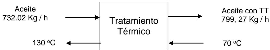
**Figura 5.11.** Requerimiento de Energía en el Tratamiento Térmico.
