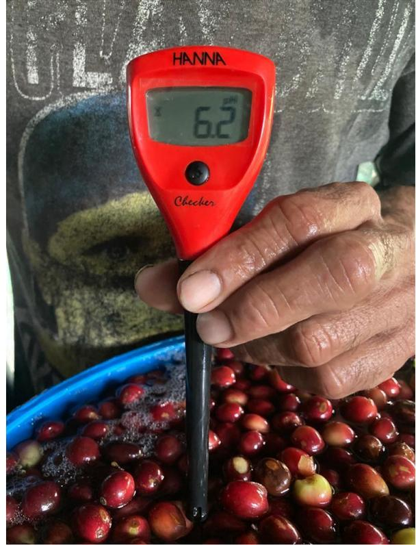
Figura O.5 Medición del pH
