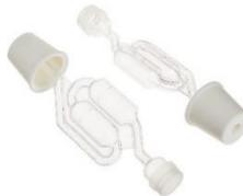
Se utilizó para permitir la salida del  $CO_2$  generado por la fermentación del café.
