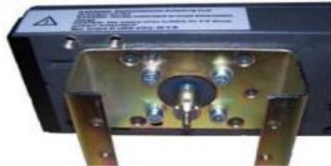
**Paso 4** Posicione el indicador amarillo en la base del acoplador.
