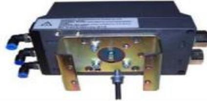
**Paso 2** Posicione el eje de salida del posicionador de modo que la parte plana (1) quede hacia arriba.
