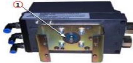
**Paso 3** Inserte el acoplador sobre el eje de salida. Antes de ajustar el tornillo de fijación del acoplador, asegúrese de que esté correctamente alineado con el lado plano del eje.
