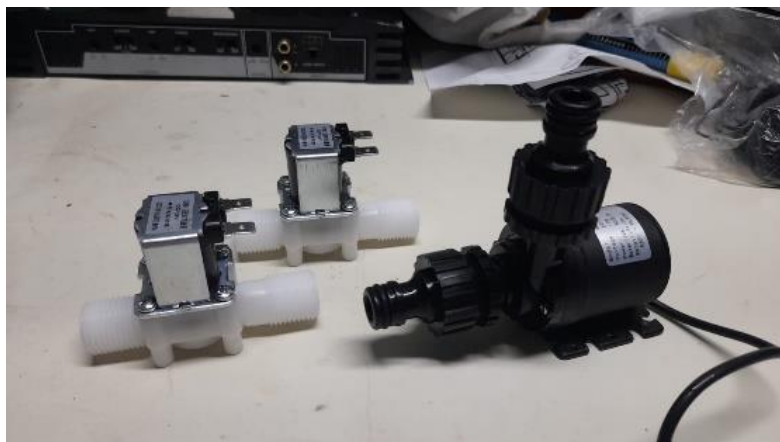
Figura 5. Válvulas solenoide y bomba de agua
