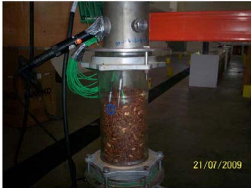
Figura H.4. Lecho empacado de semillas de nim en la columna de vidrio del equipo experimental
