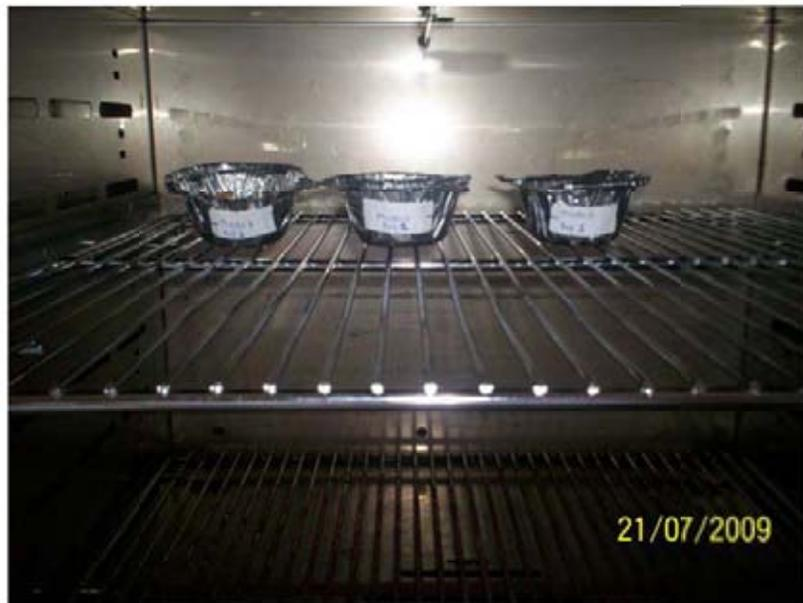
Figura H.7. Muestras para determinar la humedad inicial dentro de un horno
