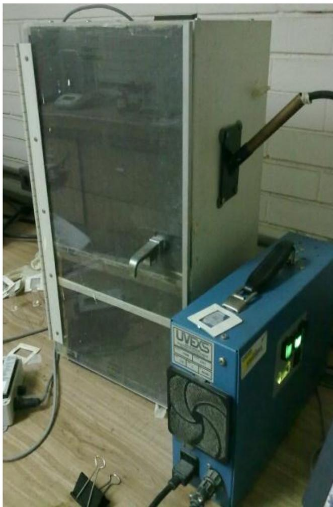
Anexo 8. Pirómetro óptico acoplado con una lámpara UV
