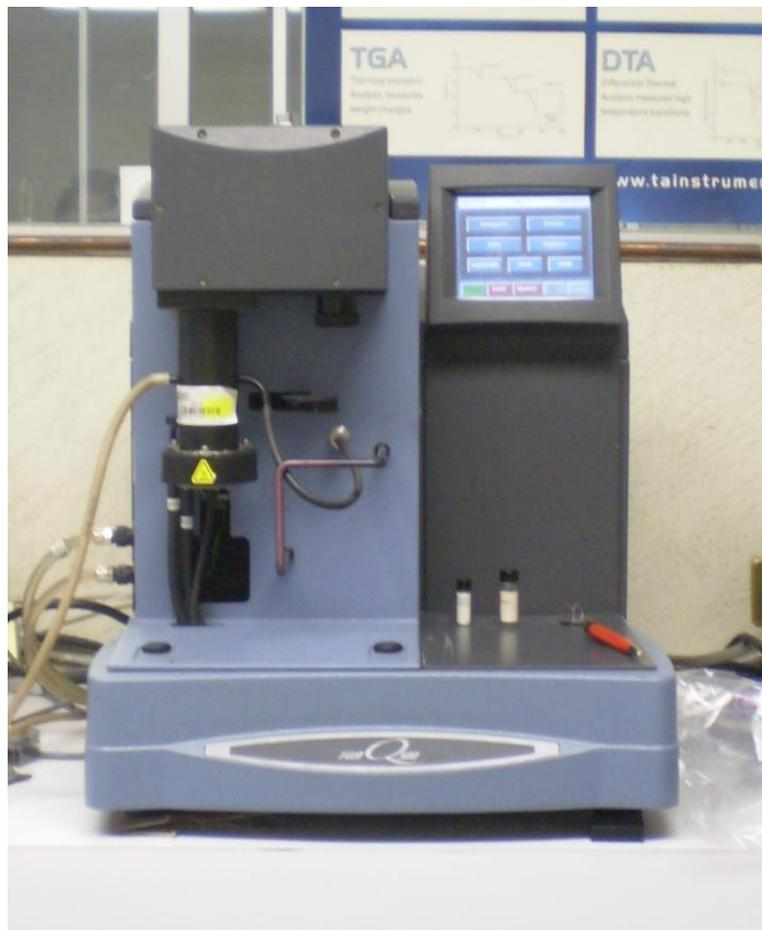
Anexo 7. Analizador Termogravimétrico
