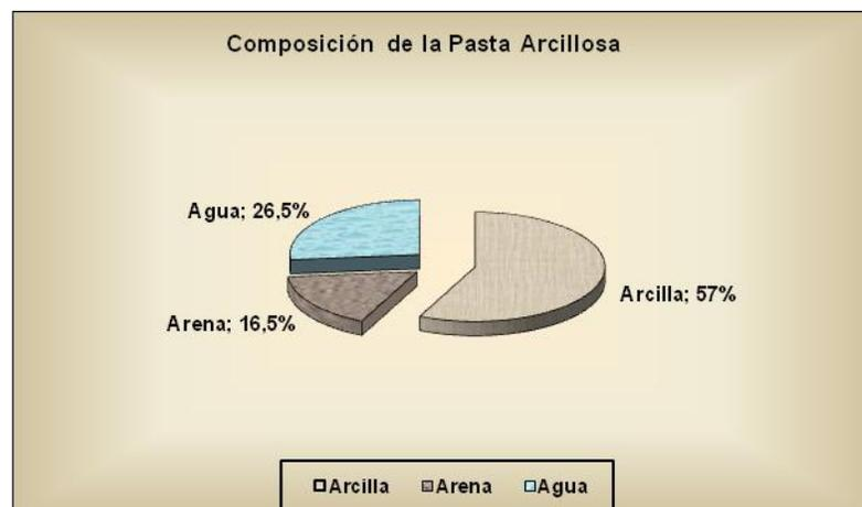
**Figura 5.9** Composición de la pasta arcillosa como base de mezcla
