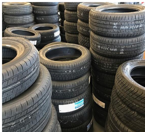
Ilustración 15, Almacenamiento vertical Ejemplo
