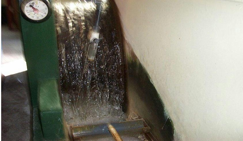
**Figura 2.1 Resalto Hidráulico.**
