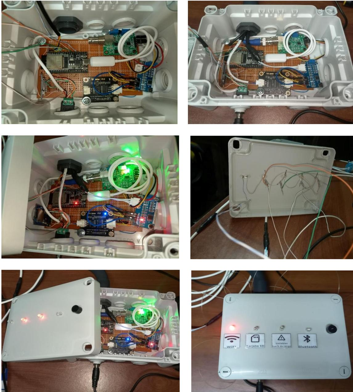
Figura 30: *Ensamblaje final del dispositivo electrónico* (Fuente propia)
