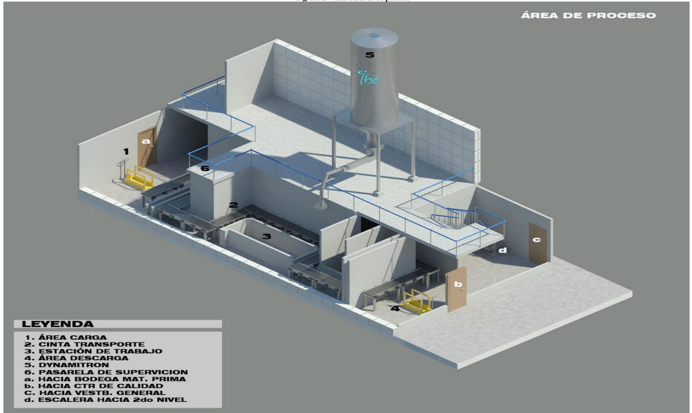
Fig. A.7.4 Isométrico del área de proceso
