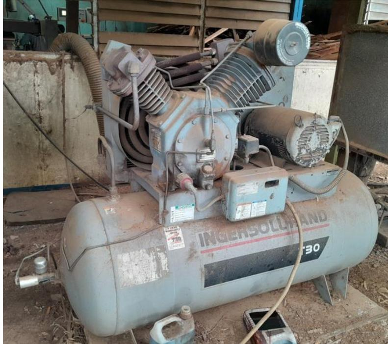
Figura 21: Compresor utilizado en la planta
