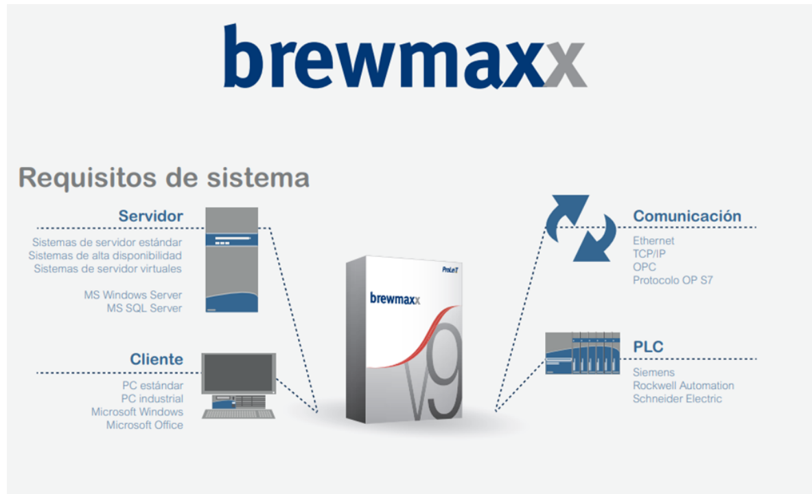
Figura 4. Estructura de sistema de control Brewmaxx.
