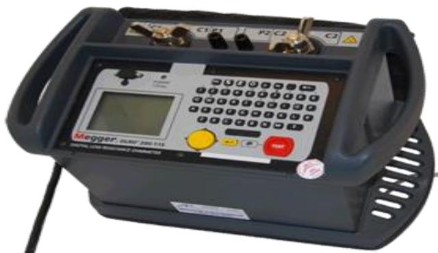
Figura No 12. Equipo de Medición para Interruptores de Media y alta Tensión.
