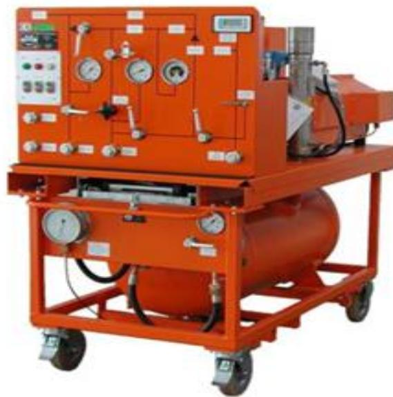
Figura No 16. Equipo de Extracción de Gas SF6 y Vacío de Interruptores de Potencia.
