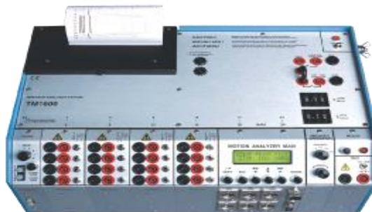
Figura No 17. Equipo de prueba de Tiempo de Operación de Interruptores de Media Y Alta Tensión.
