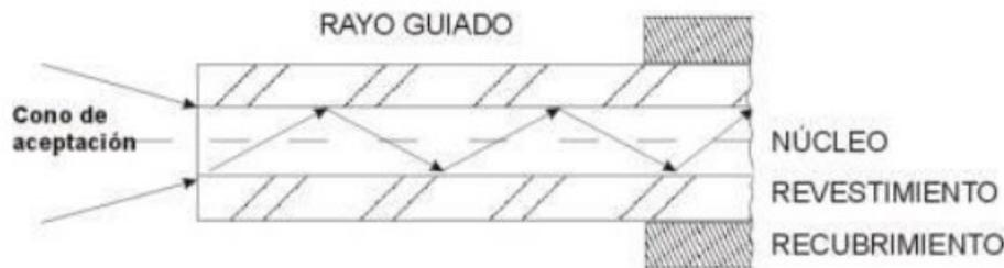
Figura 5: Estructura de la Fibra Óptica.
