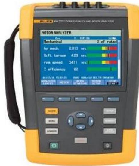
Ilustración Analizador de Redes FLUKE
