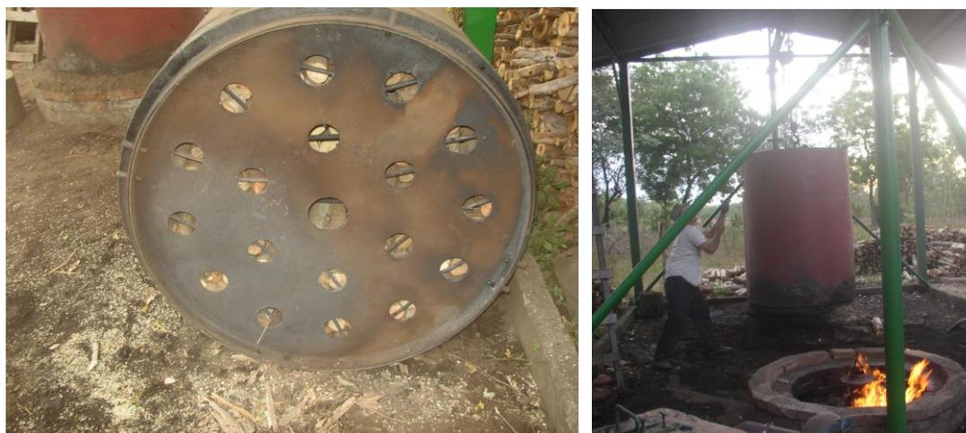
**Fotografía 20.** Contenedor con la tapa puesta (Izquierda), Contenedor alzado y siendo posicionado sobre la base (Derecha).
