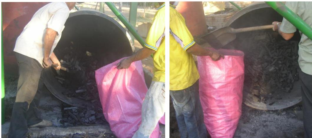
**Fotografía 24.** Descarga del carbón y empaçado, para lo cual se usa una pala plana.
