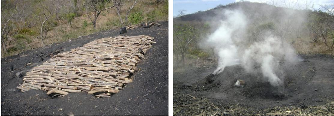
**Fotografía 1.** Parva cargada de leña (Izq). Parva en funcionamiento (Der).
