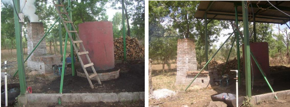
**Fotografía 21.** Izquierda: proceso de carbonización antes de encender el quemador de gases. Derecha: proceso de carbonización con el quemador de gases en funcionamiento.
