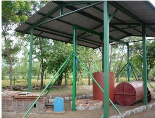
**Fotografía 5.** Horno Contenedor y sus componentes.
