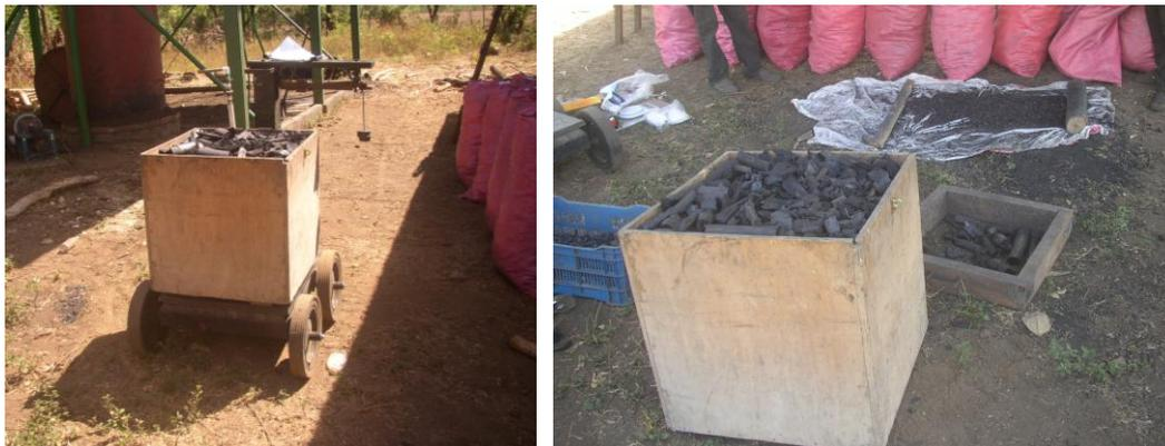
**Fotografía 11.** Determinación de la densidad a granel y fracciones comercial y no comercial.
