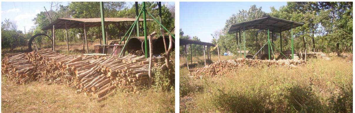
**Fotografía 18.** Leña apilada a la par de los hornos y al sol para permitir su secado.
