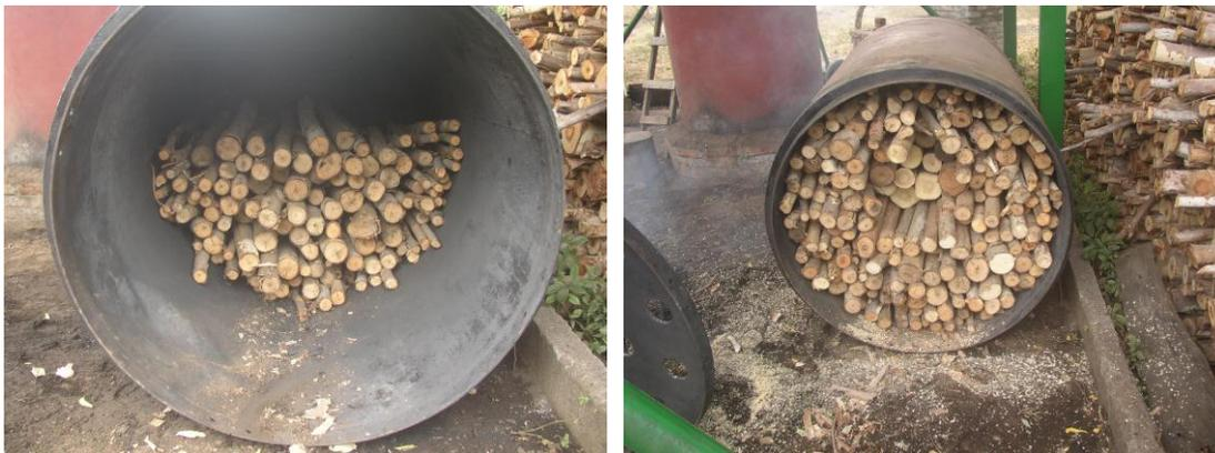
**Fotografía 19.** Carga de leña: 1er nivel a medio completar (Izq), 2do nivel completo (Der).
