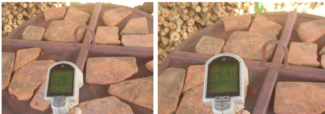
**Fotografía 22.** Registro de la temperatura de carbonización.
