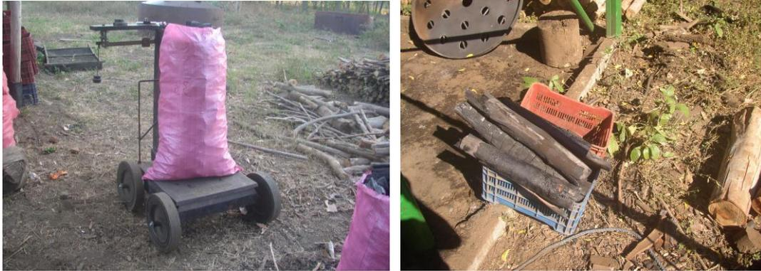
**Fotografía 10.** Pesaje del carbón producido (izquierda), leña sin carbonizar (derecha).
