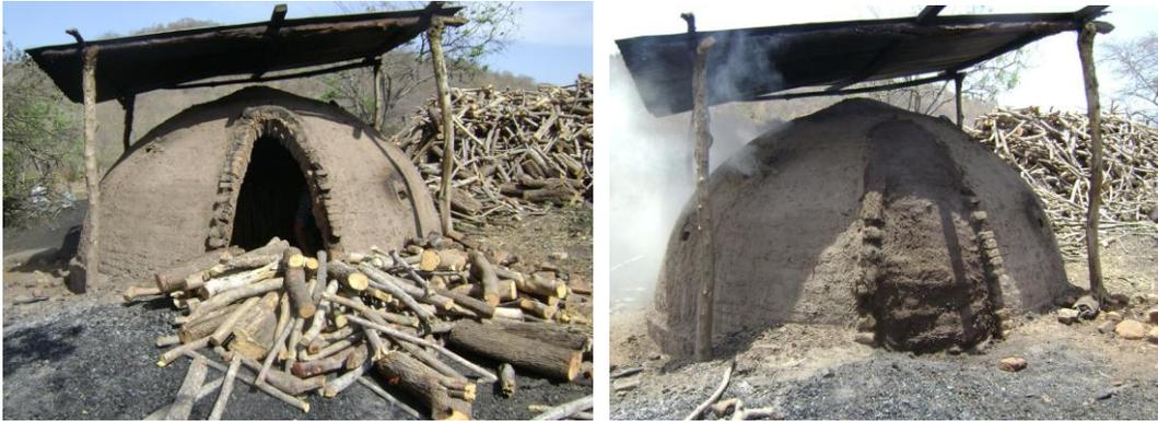
**Fotografía 2.** Carga del Horno Media Naranja con leña (Izq.). Horno Media Naranja en funcionamiento gases saliendo por las ventanas (Der.).
