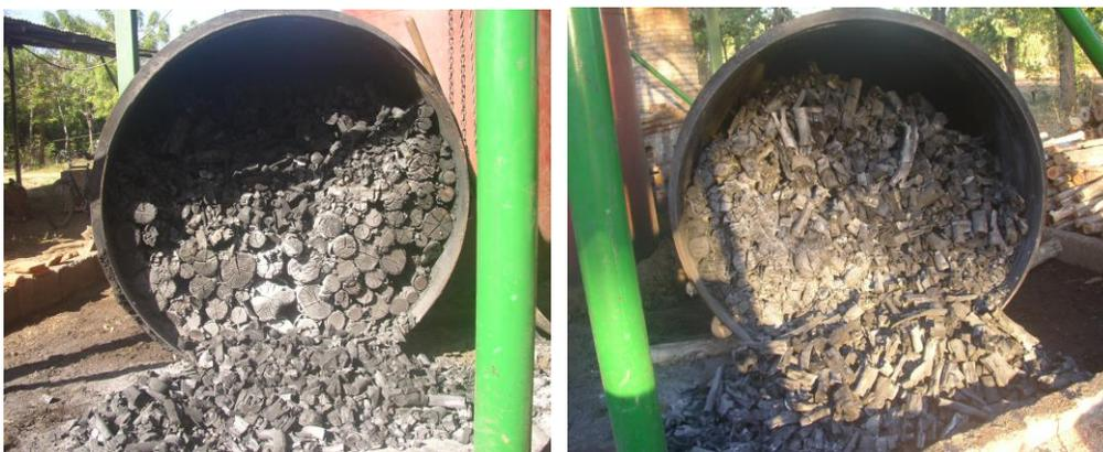
**Fotografía 26.** Carbonización dispareja en el ensayo 1 (Izq), Ensayo 11 (Der).
