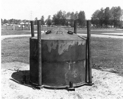
**Fotografía 3.** Horno metálico TPI.
