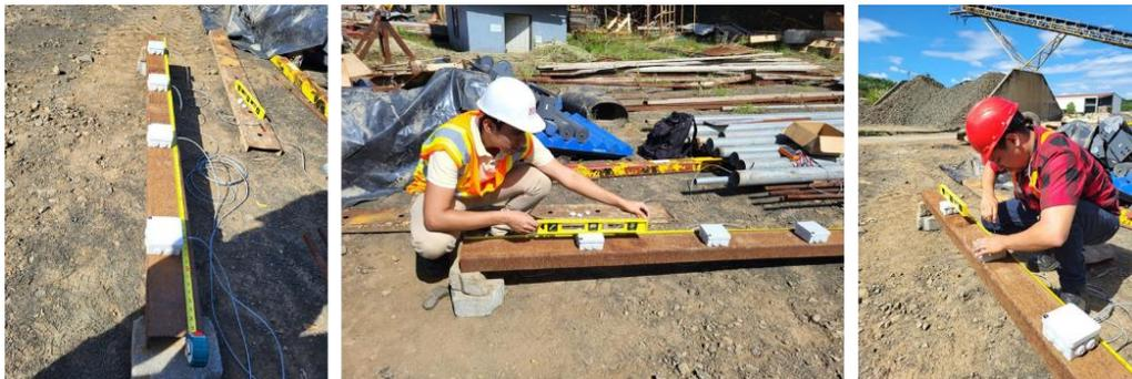
Figura 72. Colocación de sensores sobre la viga.
